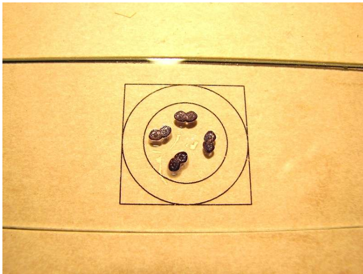
Abbildung 12: Arrangieren der Schnitte auf dem Objektträger mit Hilfe der Schablone. Um genügend Abstand zum Deckglasrand zu halten, dürfen die Präparate nur innerhalb des inneren Kreises liegen.
