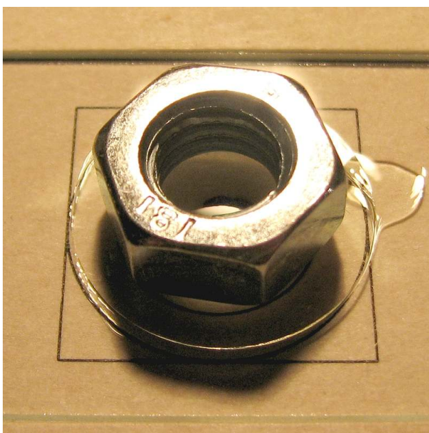
Abbildung 15: Eine M8 Mutter auf dem Deckglas, je nach Präparat können mehrere Muttern übereinander geschichtet werden, um den Schnitt plan zu bekommen.
