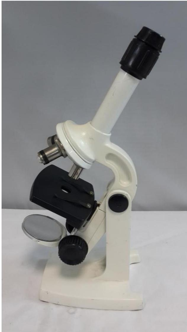
Das Mikroskop ist mit pankratischem Okular und einem Revolver für Schnellwechsel-Objektiv ausgestattet, so dass stufenlose Vergrößerung möglich ist.
