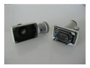
Mit einer Präpariernadel oder einem kleinen Schraubendreher werden die Federn von ihren Bolzen heruntergehoben.
