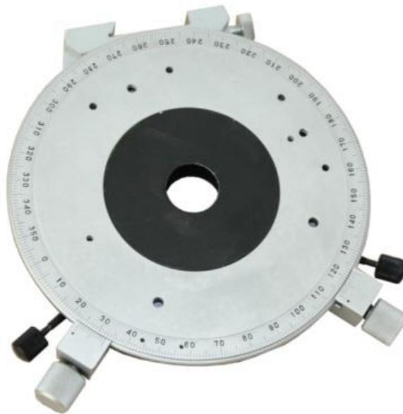
In der Mitte des Tisches befindet sich eine herausnehmbare Platte mit Öffnung für Durchlichtbetrachtung. Diese Platte kann für Auflichtbeobachtung durch eine Platte ohne Öffnung ersetzt werden.
