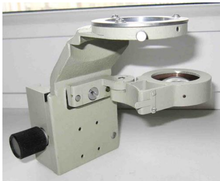
Kondensor mit Polarisator; drehbar mit Skala, sowie Klapplinse. (die obere Abbildung zeigt falsche Montage)
