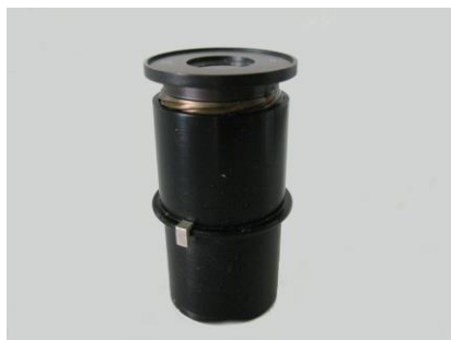
Die Okularaufnahme des Binotubus. Der Schlitz dient zur genauen Positionierung der Okulare (Spezialokulare, spannungsfrei mit Stift zur Ausrichtung)
