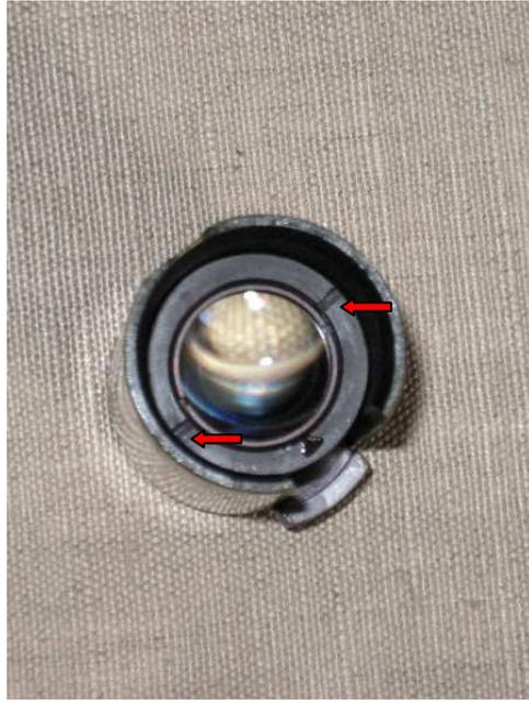
Die Linsen liegen nun frei und können einzeln ausgeschraubt werden. (Nutenschlüssel)
