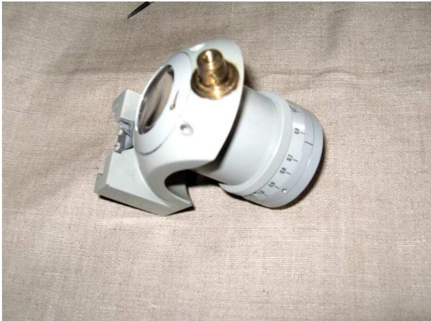
Kondensatorrevolver und Blende entfernen
