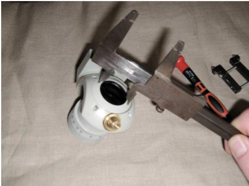
Frontlinse abschrauben (hier mit einem zweckentfremdeten,
