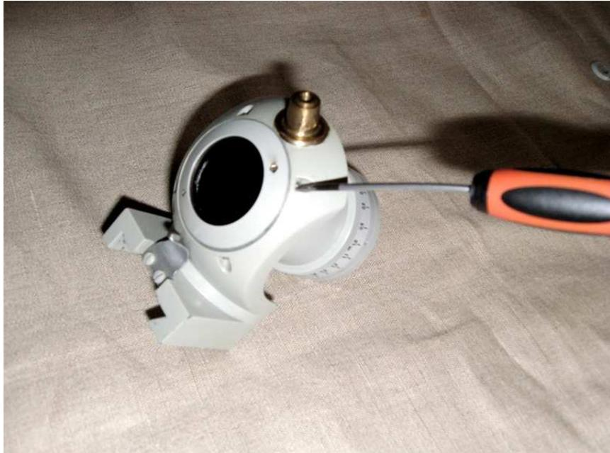
Zentrierschrauben des Kondensoreinhängers lösen
