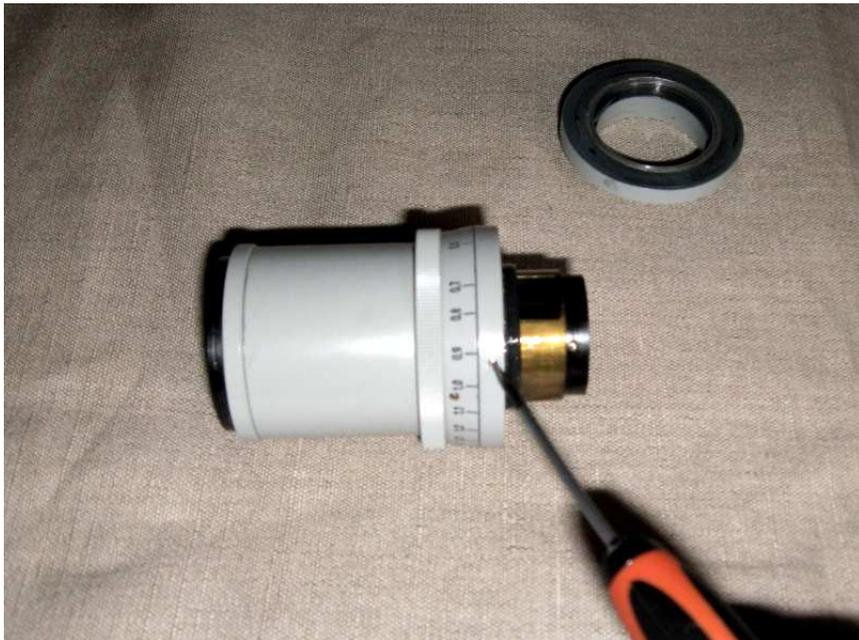
2er Ring: schrauben lösen (3x) und abziehen (kein Gewinde, nur gesteckt)
