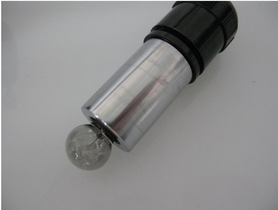
Die Lampenfassung mit Glühlampe 6V1501 E10 Fassung (Wolframwendel).
