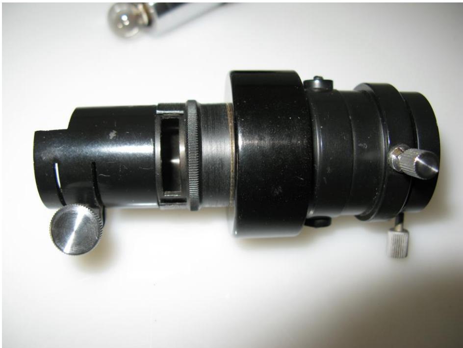
Das Lampengehäuse. Rechts im Bild die Befestigung für die Lampenfassung. Links die Befestigung für das Polarisatorgehäuse. In der Mitte der geöffnete Filterschacht.
