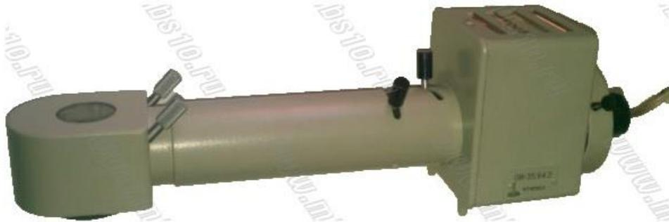
Der Beleuchter OI-35 ist zur Erzeugung Köhlerscher Beleuchtung geeignet und wird an den Stativen der neueren Biolam-Serie verwendet, bei denen er in die im Fuß befindliche Öffnung eingestellt wird.
