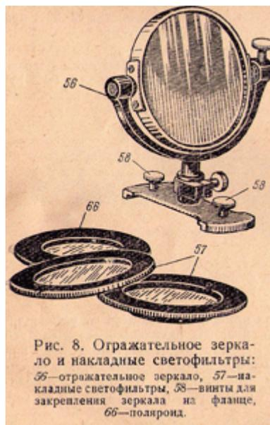
Рис. 8. Отражательное зеркало и накладные светофильтры: 56—отражательное зеркало, 57—накладные светофильтры, 58—винты для закрепления зеркала на фланце, 66—поляроид.
