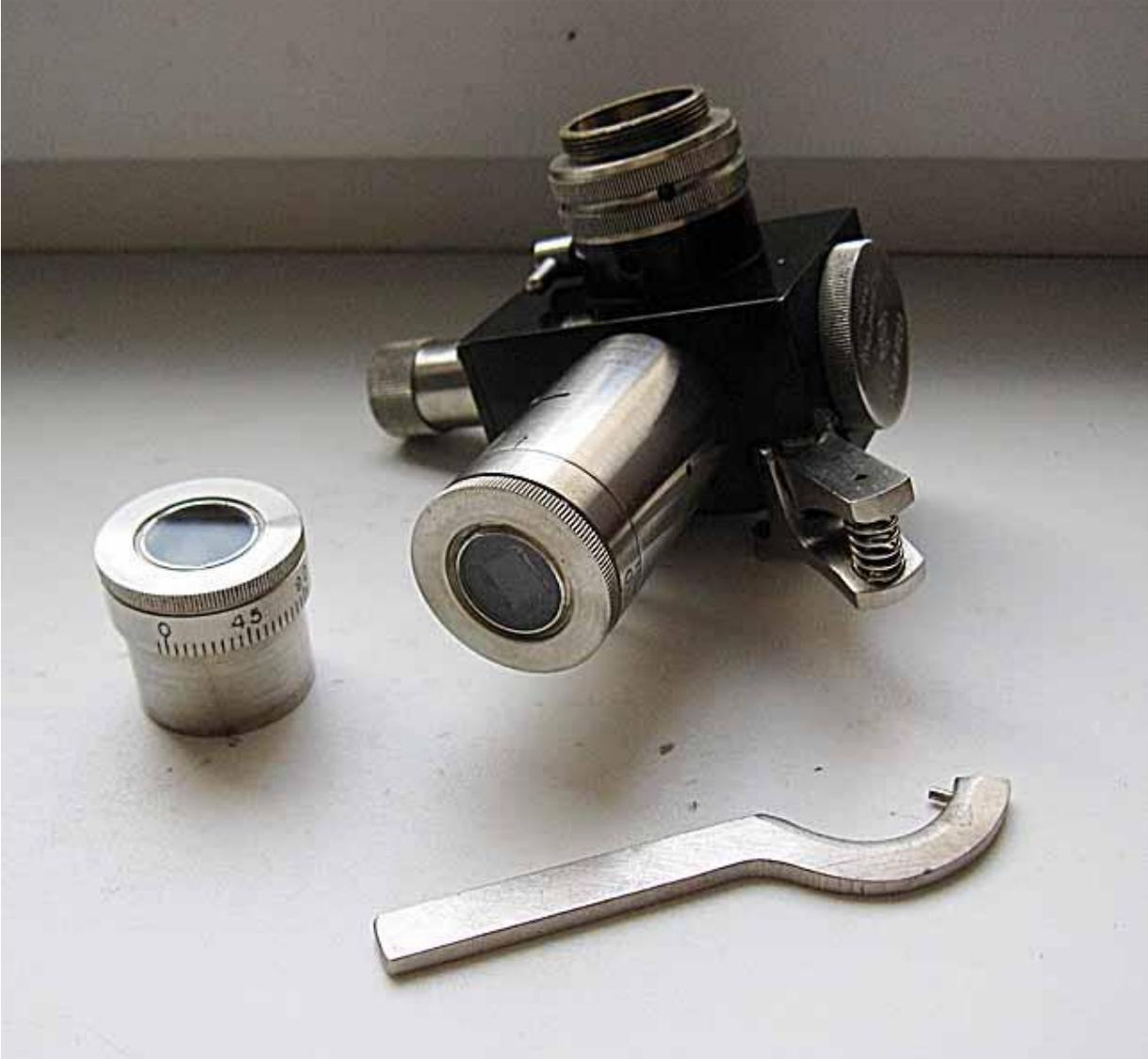
Jedes Objektiv wird in die Halterung geschraubt, selbstzentrierend mit Schlüssel 37. Oberhalb der Schwalbenschwanznut sind Schlitzlöcher vorgesehen, in welche der Schieber 38 mit dem Analysator eingesetzt wird.
