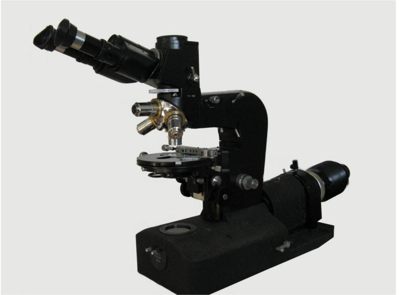
Interessanterweise habe ich noch einen Adapter M43 / Lomo(Zeiss/J)-Schwalbe gefunden, welcher genau an den Fotoausgang passt. Somit kann ich jetzt auch meine Mikroskopkamera (Euromex-DC5000) einstecken. Mit dem Vario-Tubus können nun auch Objektive für andere Tubuslängen verwendet werden (Leitz oder Hertel&Reuss mit 170mm oder Lomo-Epi mit 190mm).
