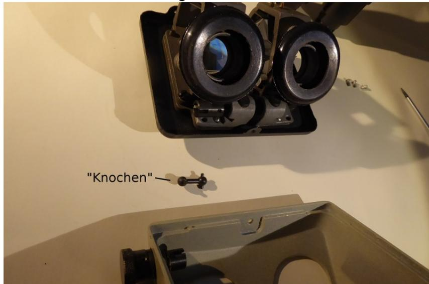
3. Die beiden Gummidichtungen um die Gewinde der Okularstutzen abziehen
