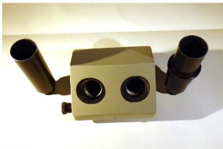
2. Die drei Schrauben der Abdeckung lösen und Abdeckung zur Seite der Stellschraube für den Augenabstand abziehen. Dabei fällt ein kleiner „Knochen“ heraus, der im zusammen-gebauten Zustand die Stellschraube gelenkig mit dem Verstellmechanismus für den Augenabstand verbindet.
