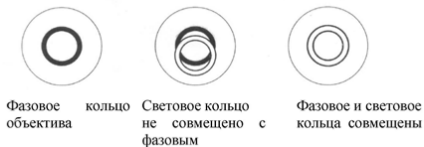
Abb. 2 Sichtfeld des Zentrierteleskops
