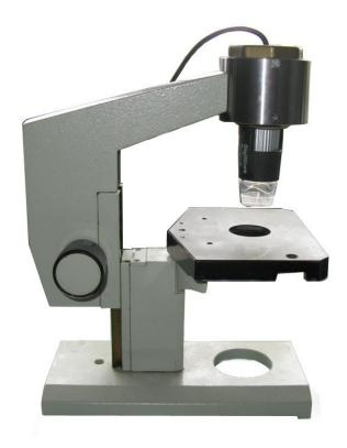
Vom Lupenstativ (ohne Feintrieb) werden Revolver und der Tubus abgenommen. Die im Kopf freiliegende Halteschraube wird entfernt und der Kopf abgenommen. An Stelle des Kopfes wird eine gedrehte Hülse angebracht in der mit 6 Schrauben (jeweils 3 im oberen Kreis und 3 im unteren Kreis) die dnt-Mikroskopkamera (handheld) befestigt wird.
