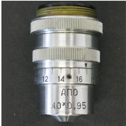
Apochromat 40x 0,95 mit Deckglasstärkeneinstellung
