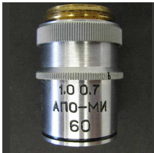
Apochromat 60x 0,7-1,0 Ölimmersion mit Apertureinstellung
