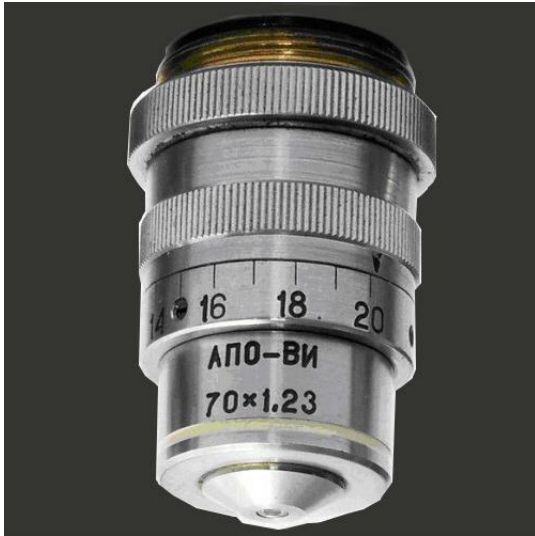
Apochromat 70x 1,23 Wasserimmersion mit Deckglasstärkeneinstellung
