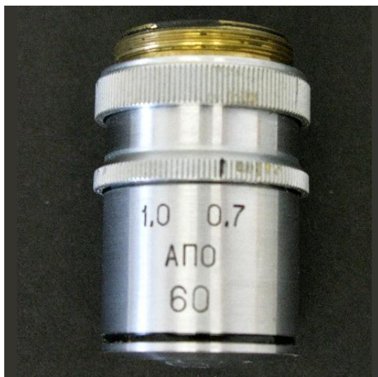
Apochromat 60x 0,7-1,0 mit Apertureinstellung
