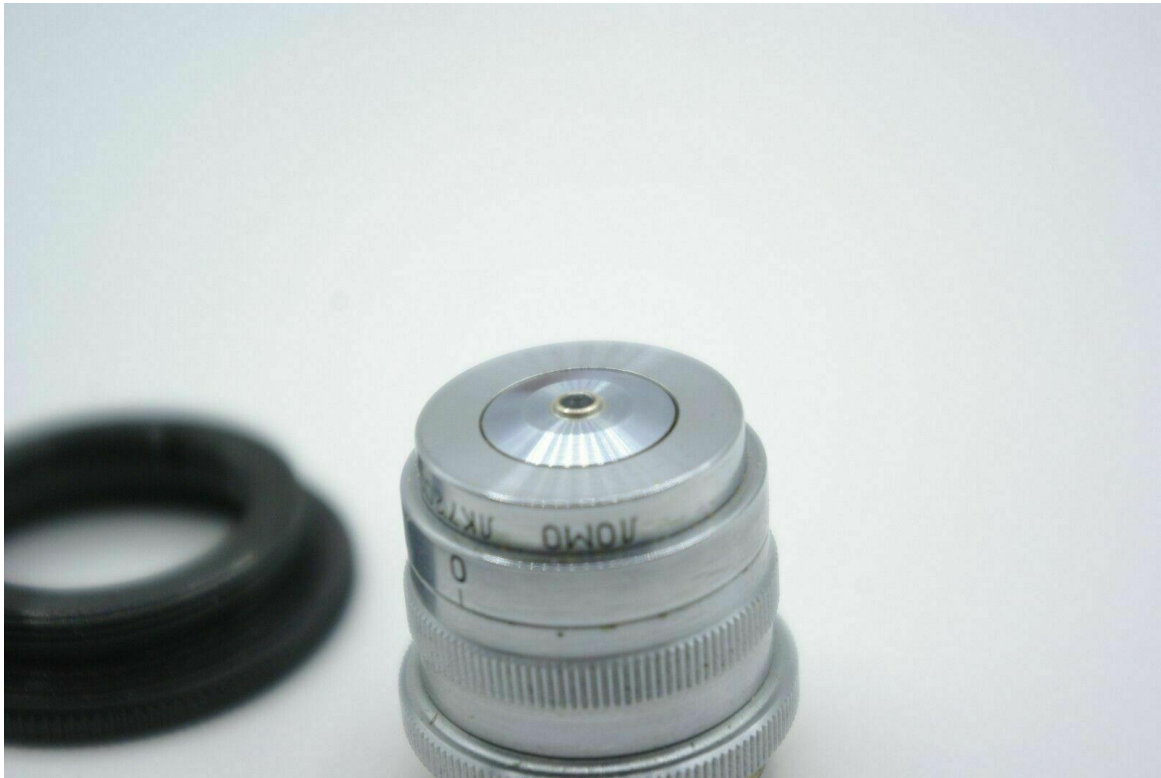
Objektiv mit 190mm Tubuslänge für die „großen“ Stative oder Petrografischen Mikroskope. Es handelt sich um ein Kontaktobjektiv, das Deckglas entfällt, daher die hohe Apertur.
