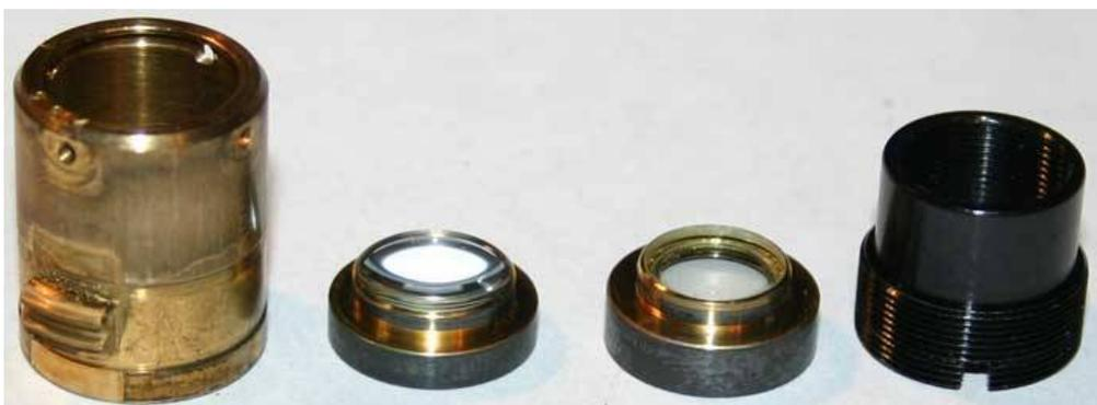
Nachdem Sie alle Teile gereinigt haben, ist es Zeit, sie zurück zu montieren. Zunächst montieren Sie den inneren Block, wenn Sie ihn auseinandergenommen hatten. Legen Sie den inneren Block in den Körper. Stellen Sie sicher, dass Sie die Markierungen auf dem Block und dem Körper ausgerichtet haben. Ich habe keine Teile geschmiert, da sie sich leicht bewegten. Aber Sie müssen eventuell etwas Fett hinzuzufügen.
