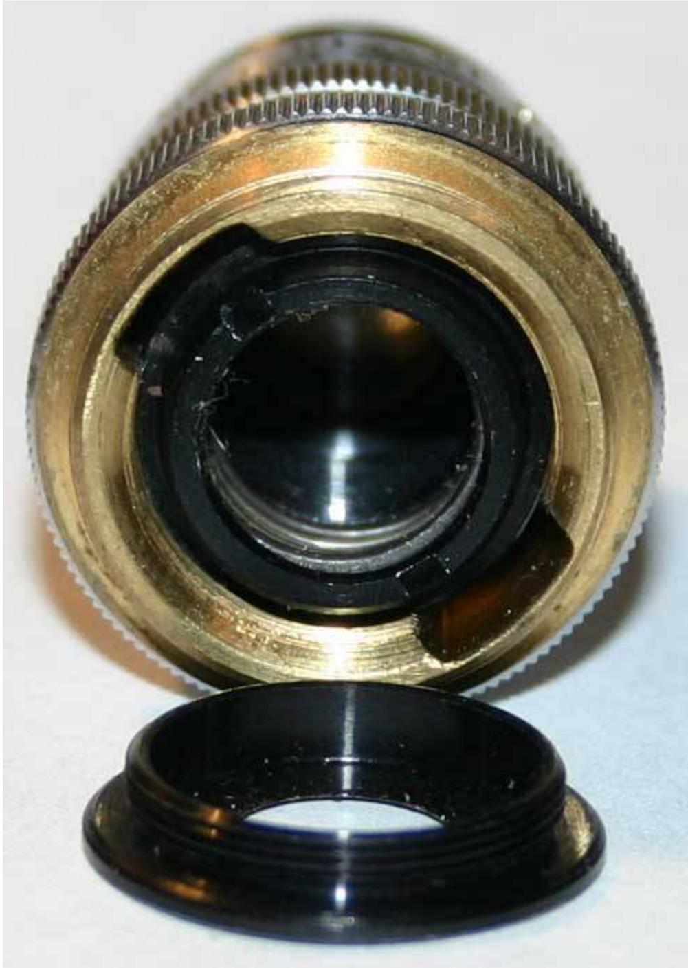
Als nächstes müssen Sie den innenliegenden schwarzen Ring abschrauben. Dies ist etwas komplizierter, denn er hält eine Feder. Sie sollten mit dem Schraubendreher in den Rillen gegen den Uhrzeigersinn drücken, um den Ring abzuschrauben. Seien Sie vorsichtig, damit die Feder den Ring nicht fortschleudert.
