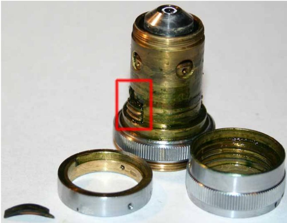
Nachdem Sie das Objektiv zerlegt haben, reinigen Sie es mit einem mit Lösungsmittel getränkten Wattestäbchen oder benutzen Sie ein Ultraschallbad. Beachten Sie, dass der Körper und der inneren Block Kreuzmarkierungen haben. Diese wurden im Werk hergestellt.
