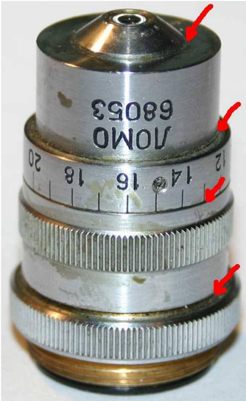
Auch an die drei Halteschrauben, die Skalenring an seinem Platz halten, sollte Lösungsmittel gegeben werden. Nach Einwirken des Lösungsmittels, nehmen Sie den Schraubendreher (Uhrmacherschraubendreher 1.4 mm oder kleiner) und lösen damit die Halteschrauben.
