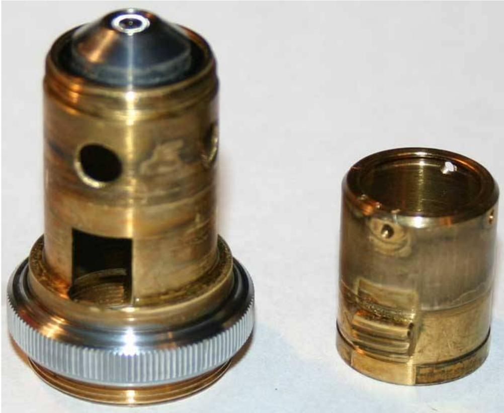
Schrauben Sie den Korrektur Ring auf den Körper. Drehen Sie den Ring gegen die Marke, die Sie während der Demontage gemacht haben, und überprüfen Sie die Lücke in den runden Löchern.
