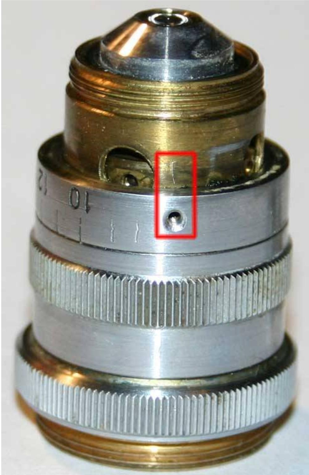
Entfernen Sie den Skalenring und beachten Sie den kleinen Teil, der die Drehung des Korrekturrings begrenzt (der Index bewegt sich innerhalb der Grenzen der Skala).
