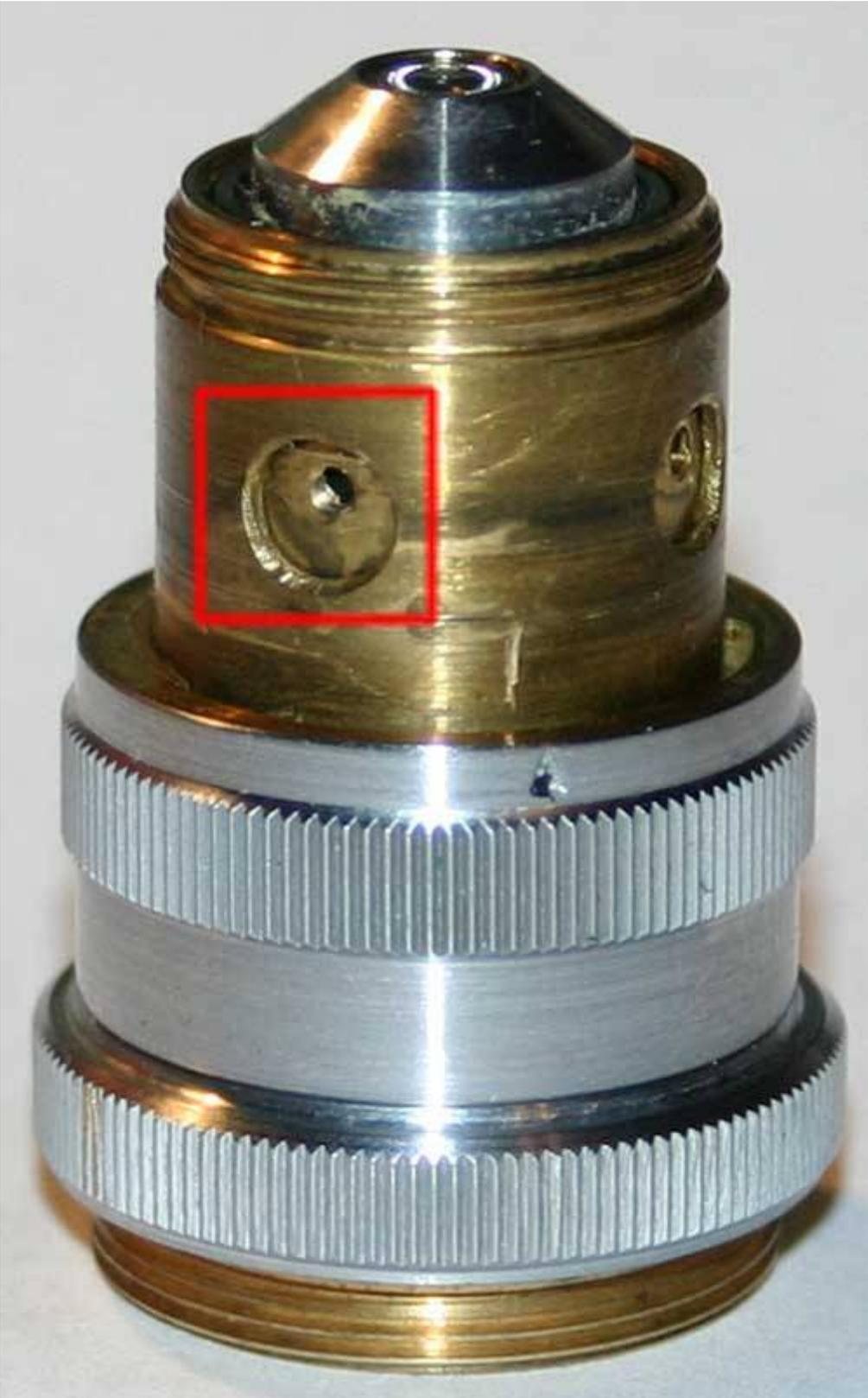
Der Spalt ist jetzt korrekt - es ist dasselbe wie wir es während der Demontage sahen. Setzen Sie den Begrenzer in den Steckplatz.
