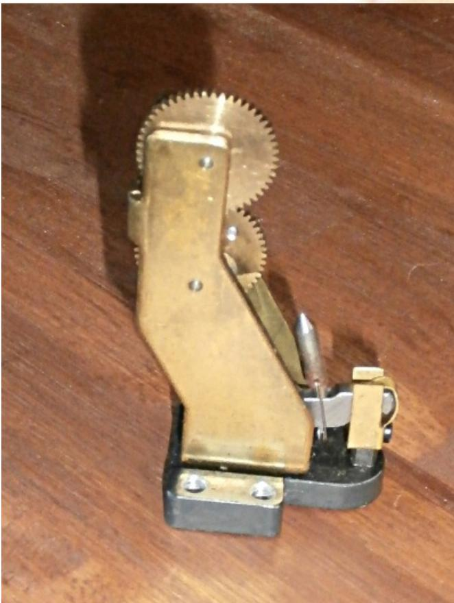
So sieht ein intaktes „Uhrwerk“ aus. Im unteren Bild sieht man den Bügel in Endstellung am Zahnrad eingesetzt. Oft ist nur dieser Bügel herausgesprungen. Um ihn richtig ein zu setzen, braucht man das Uhrwerk nicht wie gezeigt ausbauen. Man löst nur die Schraube, die sich unten rechts im Bild befindet und nimmt die Messinghaube ab, die den Hebel im Lager hält. Dann nimmt man den Bügel heraus
