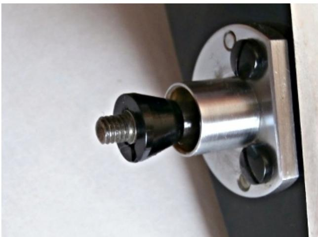
Den Kunststoffkegel abziehen und Achse herausziehen!
