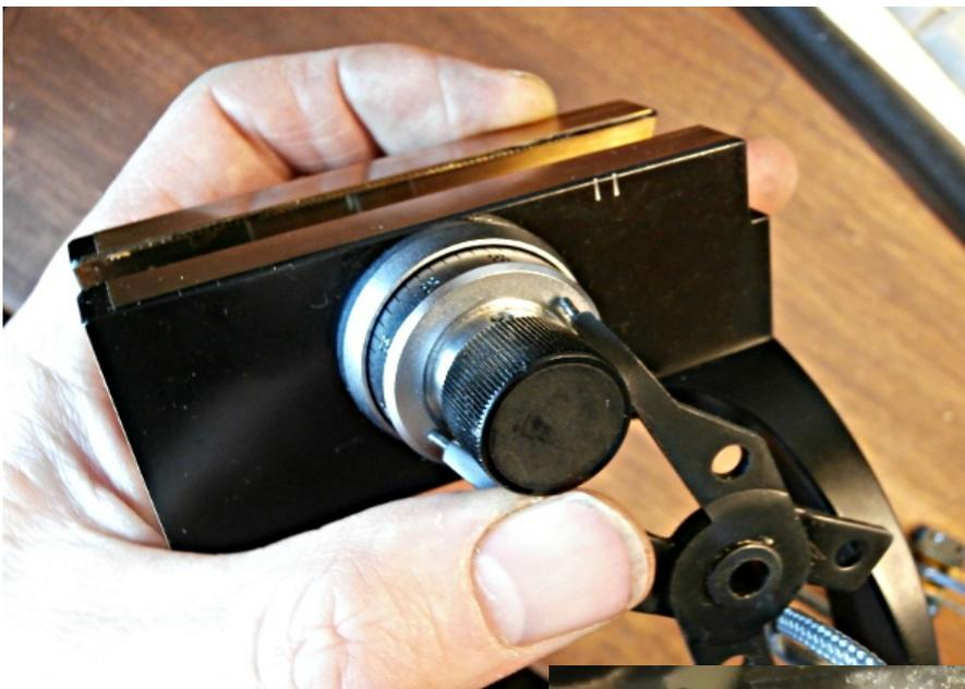
Als nächstes löst man den Überwurf mit der Skalierung von der Achse des Feintriebes. Das geht mit dem Aufsatz einer Seegerringzange.
