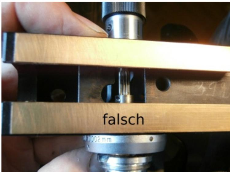
Der Einbau erfolgt in umgekehrter Reihenfolge, wobei darauf zu achten ist, dass sich der Feintriebhebel in der unteren Endstellung befindet (sonst lässt er sich nicht einschieben):
