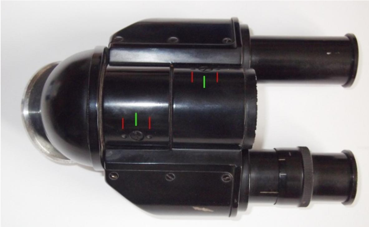
Wenn der Augenabstand zu leichtgängig ist (Tubus rutscht unter Eigengewicht zusammen), kann man an den 4 kleinen rot gekennzeichneten Schrauben mit passendem (!) Uhrmacherschrauben-dreher die Bremse etwas anziehen. Die 2 großen Schrauben halten die Bremse und sollten NICHT bewegt werden.
