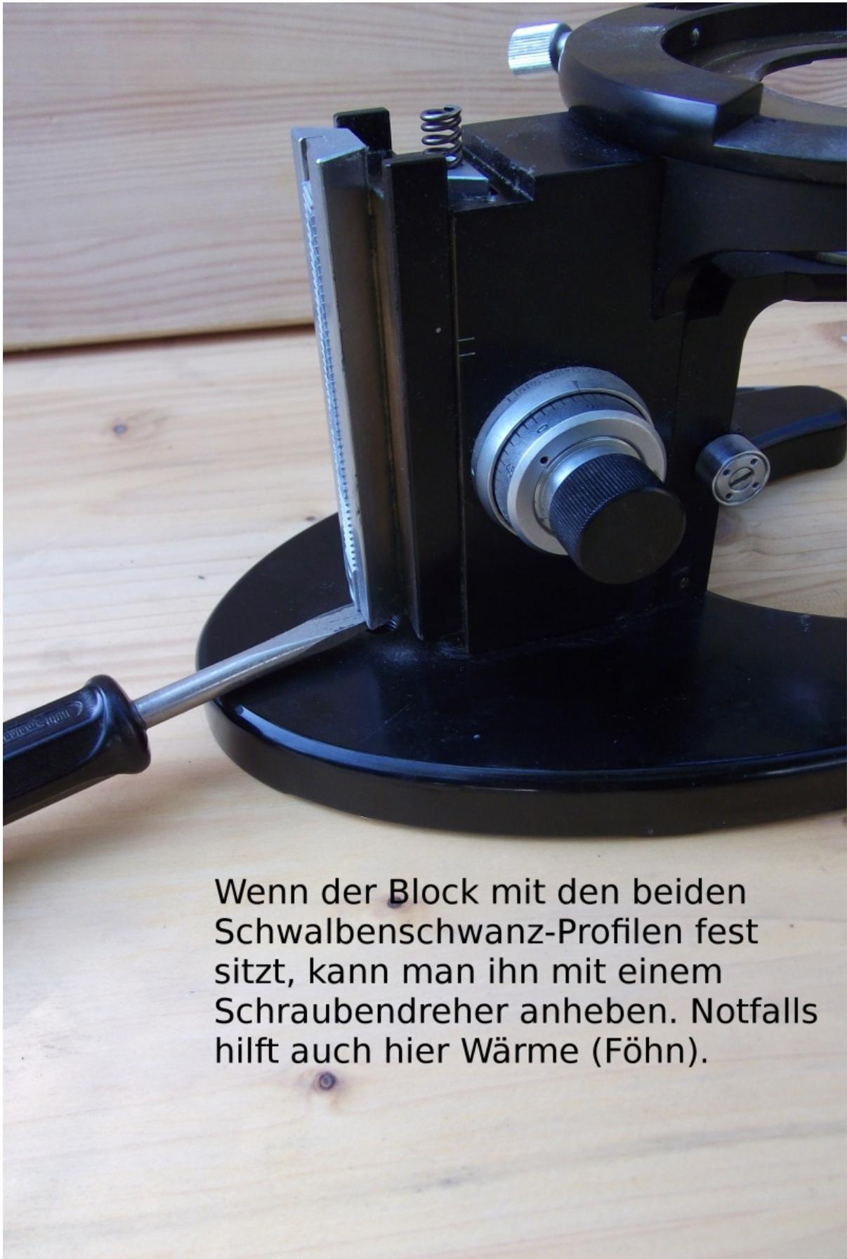
Wenn der Block mit den beiden Schwalbenschwanz-Profilen fest sitzt, kann man ihn mit einem Schraubendreher anheben. Notfalls hilft auch hier Wärme (Föhn).
