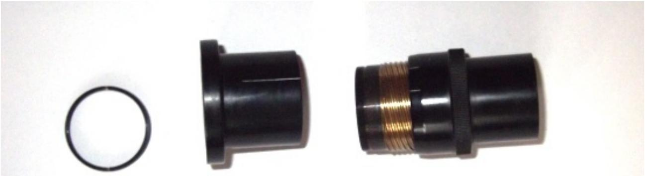
Da in diesem Bauteil keine optischen Teile sind, kann auch hier mit dem Föhn das harte Fett erweicht werden. Die zerlegten Teile in Waschbenzin reinigen, neu fetten und in umgekehrter Reihenfolge wieder zusammenbauen.
