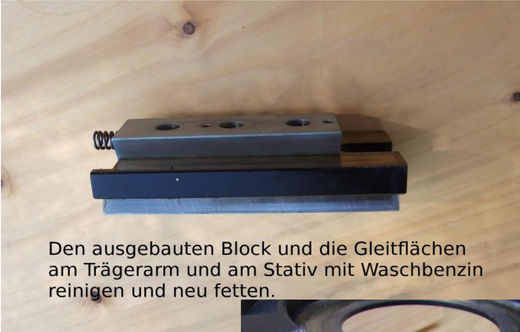
Den ausgebauten Block und die Gleitflächen am Trägerarm und am Stativ mit Waschbenzin reinigen und neu fetten.
