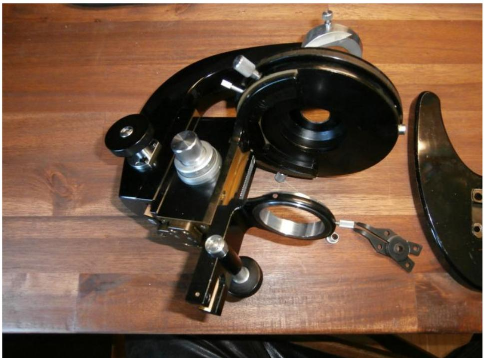
3. meist reicht es die Flächen der Schwalbenschwanzführung gründlich mit Waschbenzin zu reinigen und mit einem Lagerfett neu zu schmieren. Die Zahnstange sollte ein etwas zäheres, langfaseriges Fett bekommen, damit der Kondensator gut in der Position hält, die angesteuert wurde.
