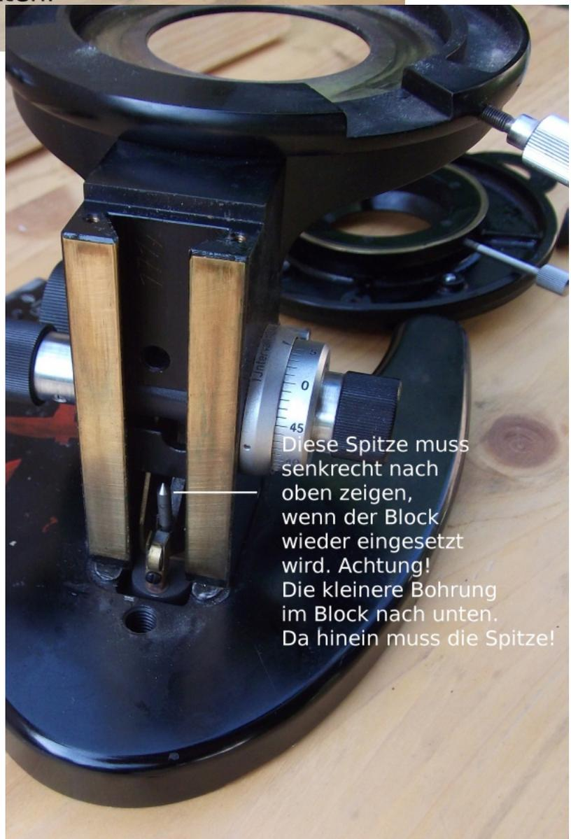
Diese Spitze muss senkrecht nach oben zeigen, wenn der Block wieder eingesetzt wird. Achtung! Die kleinere Bohrung im Block nach unten. Da hinein muss die Spitze!
