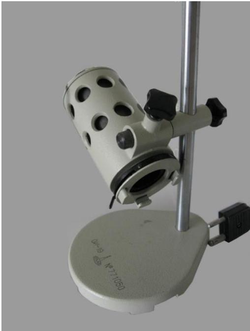
Die späteren Typen der Baureihen D- und R- mit Rechteckfuß konnten mit einer kritischen Beleuchtung OI-32 oder einer Köhlerbeleuchtung OI-35 ausgerüstet werden.
