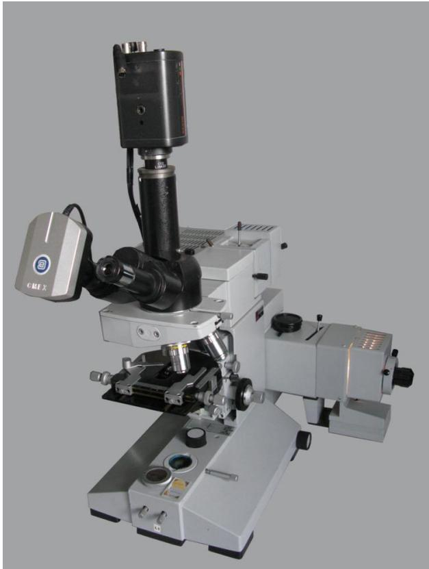
Die höchste Ausbaustufe der „Altgeräte“ ist das ML2B4.2, welches mit einer Quecksilberhochdruckleuchte ausgerüstet werden konnte. Neben diversen Farbfiltern für die Fotografie, war das Gerät mit einer internen Polfiltereinrichtung versehen, sowie mit diversen Filtern für Fluoreszenz.
