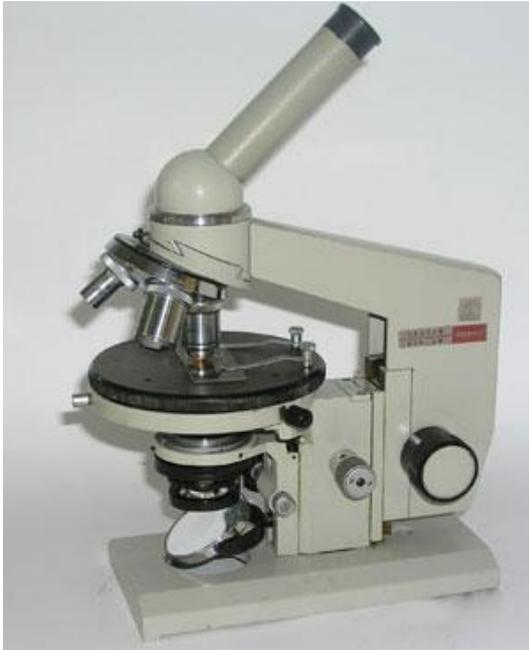
Da die Anfertigung des alten Feintriebes sehr aufwendig, und dadurch teuer war, wurde ein neuer Feintrieb, Typ „Scheibe“ eingeführt; Dickenmessungen durch ablesen der Trommel war hiermit nicht mehr möglich. Es war jedoch ein robustes Mikroskop für den Alltagsbetrieb. Dieser Typ wurde noch lange durch die Fa. Bresser vertrieben.
