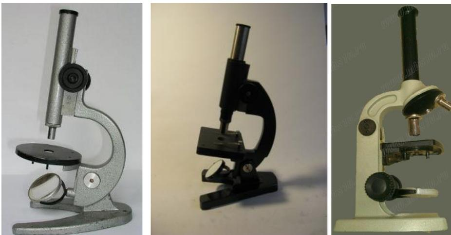
Die Beleuchtung der M-, D-, und R-Typen wurde über Spiegel realisiert. Bei den Hufeisentypen der Baureihe M- war die Anbringung einer externen Köhlerleuchte mit Hilfe eines Adapters möglich (die gleiche Art wurde auch von Zeiss/J gefertigt!)
