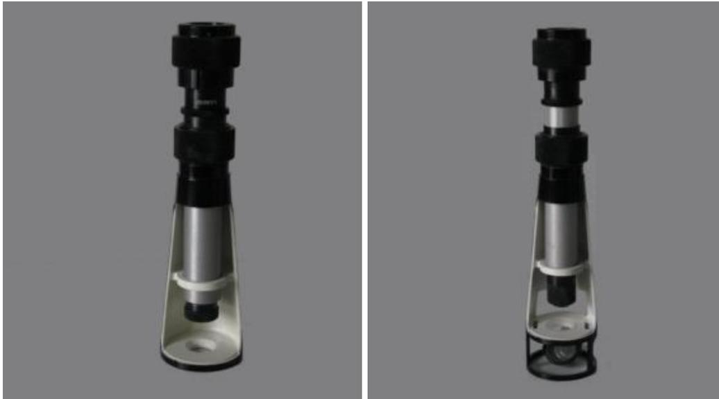
Das gleiche Gerät wurde auch als Messmikroskop für Brinellhärte hergestellt
