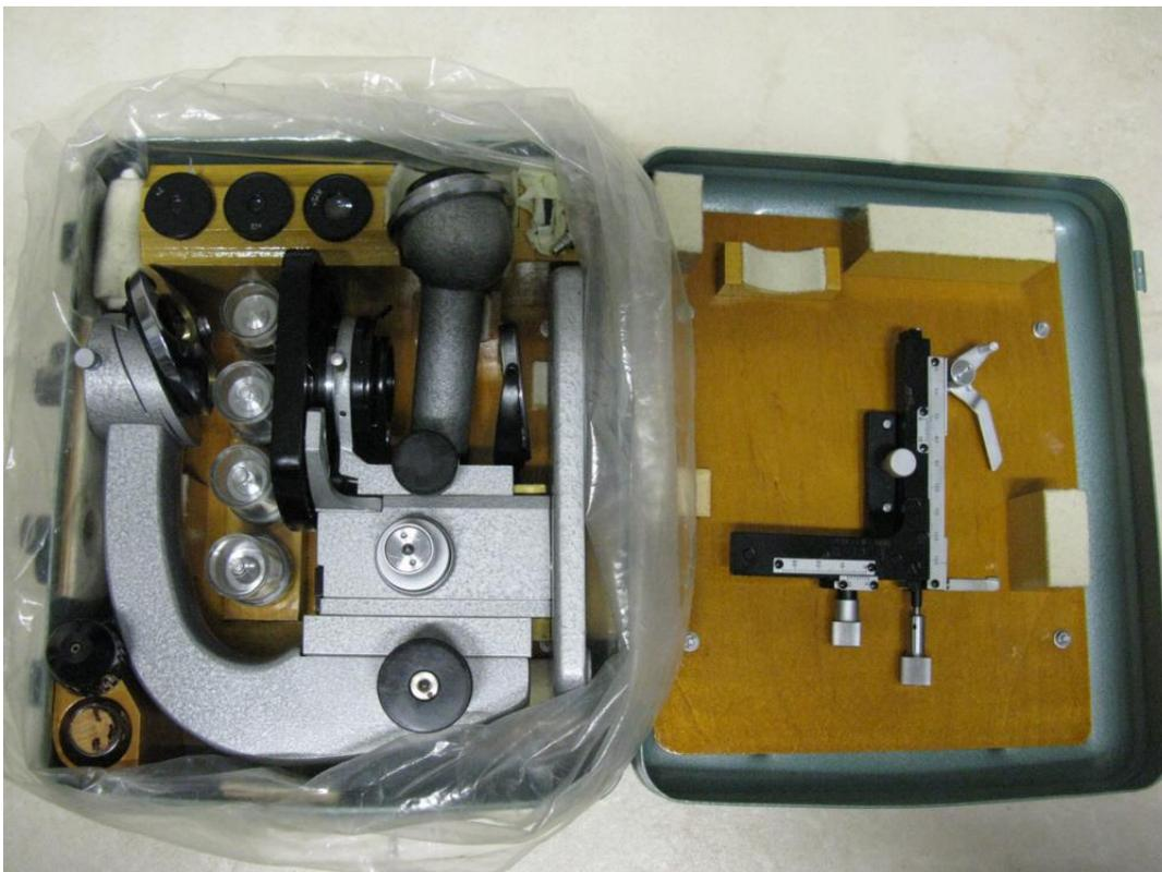
Hier die neuere Version in eckig, mit drehzentrierbarem Rundtisch als R1U4.2, aber noch mit „Uhrwerkfeintrieb“
