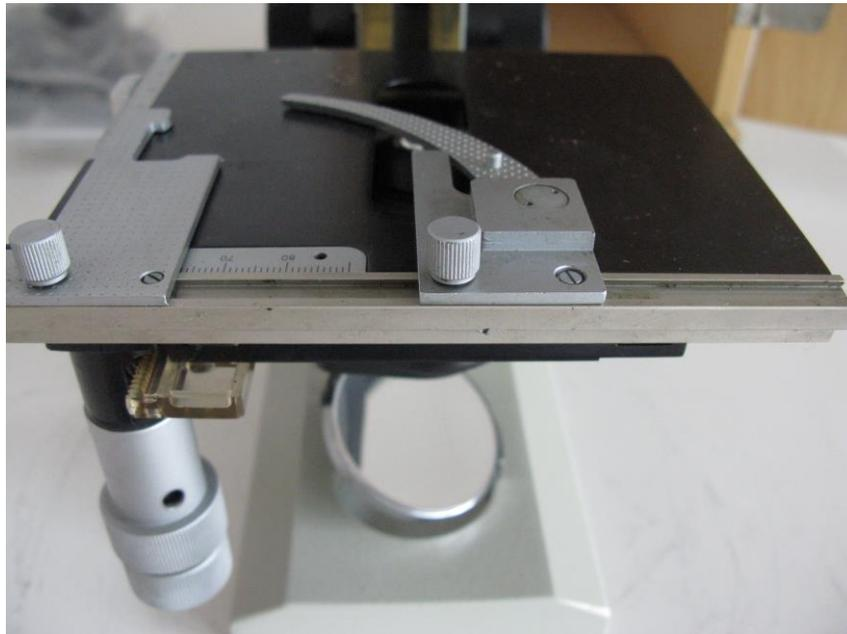
Kreuztisch für die Biolam Mikroskope, sowie für die Mikroskope mit Schnellhalter ([Lumam](#), [ML](#), [ML-A](#), [Biolam-M](#), [Biolam-I](#), etc.)
