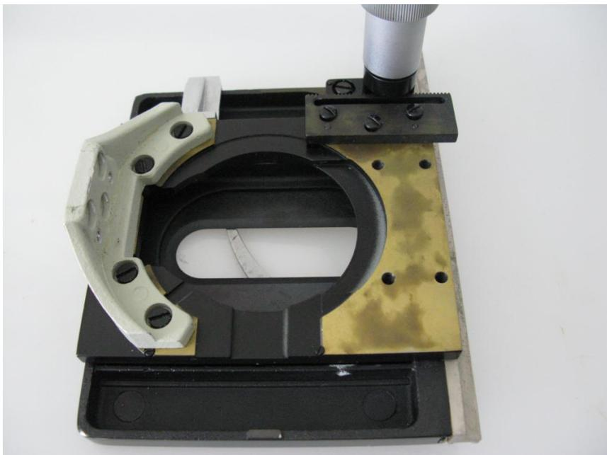
Die Unterseite weist Gewindelöcher für die Befestigung am Standardträger (links) oder am Schnellspanträger (rechts) auf.
