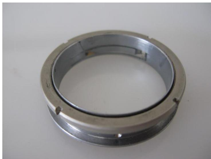
In dieser Halterung befindet sich die Zentrierfassung, welche mit den Madenschrauben ausgerichtet werden kann. Gegen Herausfallen ist sie durch eine Ringmutter gesichert. Zum lösen der Mutter wird ein Hakenschlüssel benötigt. (diesen Schlüssel kann man sich leicht aus Fahrradwerkzeug selbst herstellen).
