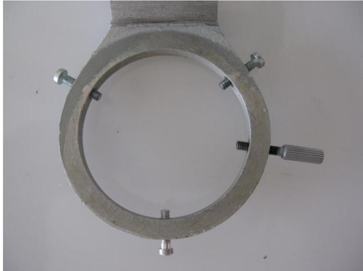
Kondensorhalter von unten gesehen. Die Madenschrauben wurden zur besseren Darstellung durch normale Schrauben ersetzt. Für den normalen Betrieb müssen jedoch Madenschrauben verwendet werden, da der Kondensor sonst nicht in die oberste Stellung gefahren werden kann; die Schraubenköpfe schlagen am Tisch an!
