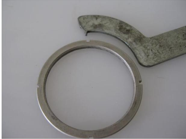
Ringmutter mit Hakenschlüssel (Eigenbau)
