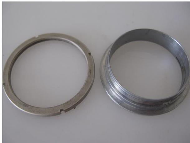
Die Zentrierfassung muss so ausgerichtet werden, dass die vordere Madenschraube mit der Spitze in die Vertiefung der Fassung eingreift.
