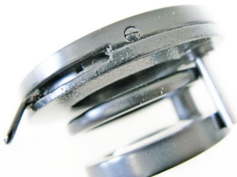
Befestigungsschrauben der Blende
