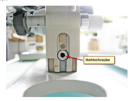
Die Prismenführung der Kondensorhalterung ist oben mit einer normalen Schaube und unten mit einer Hohlschraube gesichert, welche auch zur Aufnahme des Spiegelzapfens dient.
