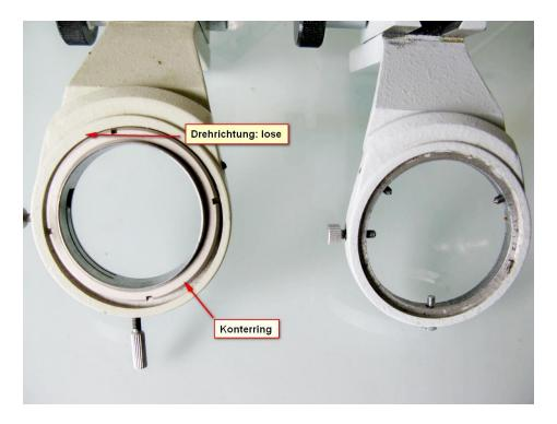
Links im Bild der Halter mit eingesetzter Hülse, rechts mit ausgebauter Hülse.
