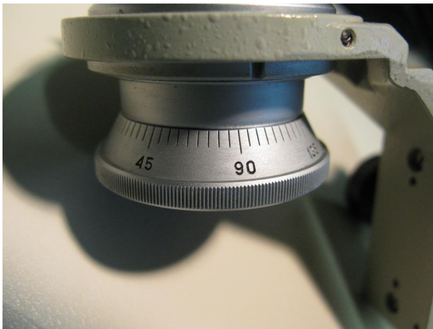
Der Kondensor wird OHNE die Justierhülse in der Kondensorhalter eingesetzt, und wie üblich, mit den drei Madenschrauben zentriert.
