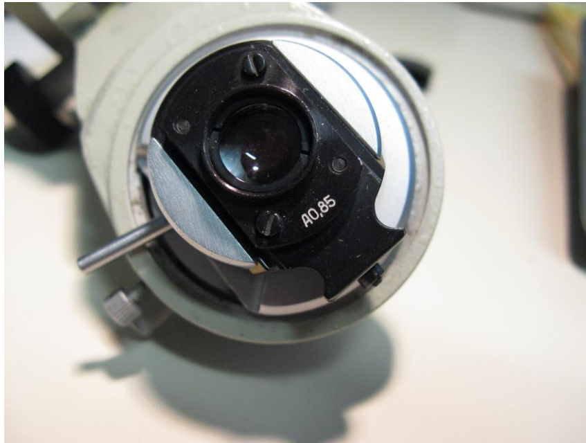
Kondensor mit eingeschobener Aperturlinse. Vorne die Justierschraube.
