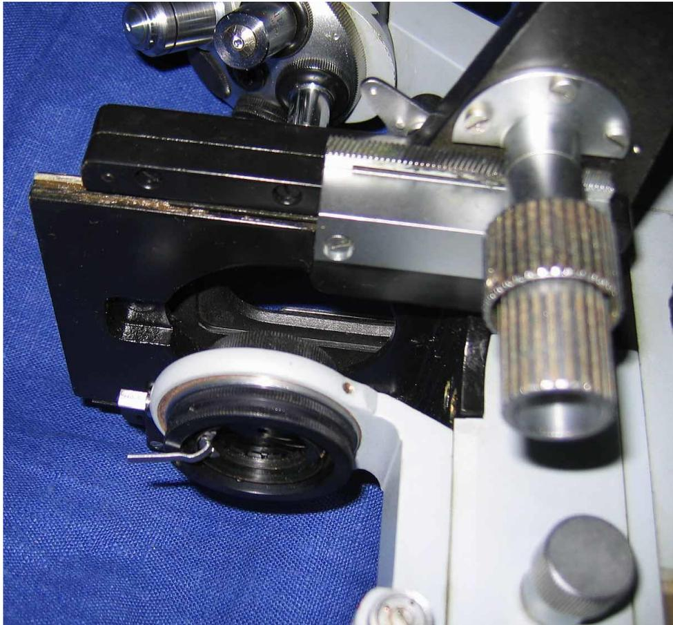
Tischunterseite mit Kondensator
