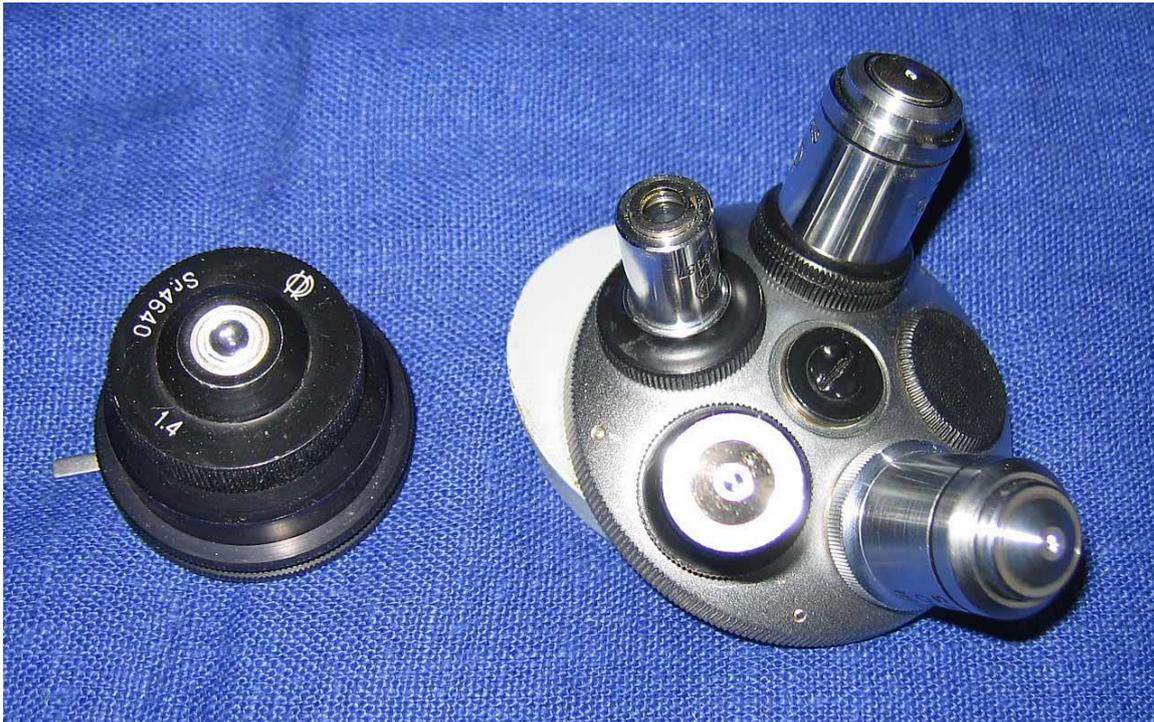
Kondensor mit NA 1,4 und 4fach Revolver (durch Schwalbenschwanzführung tauschbar)
