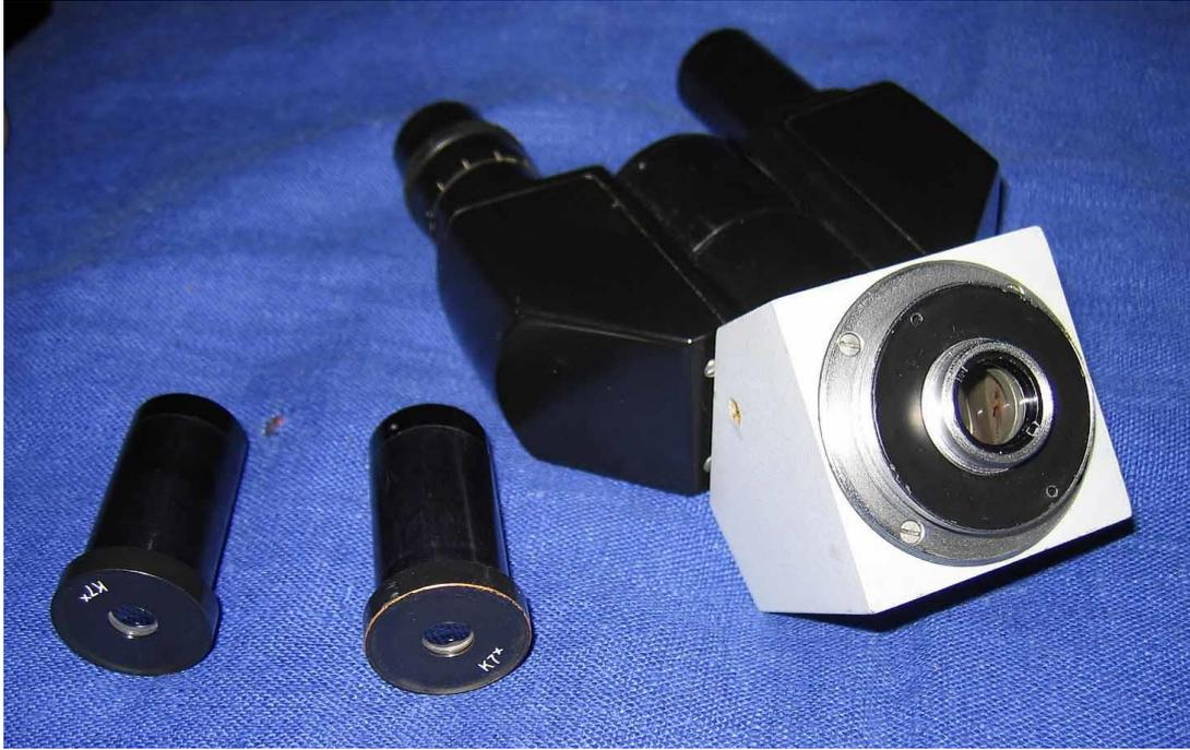
Tubus (Unterseite) und Okulare (Kompensiert)
