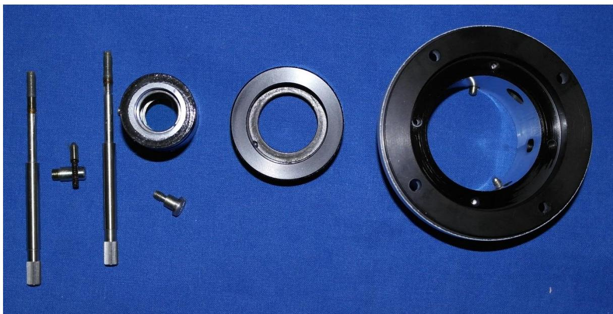
Links die beiden Langen Zentrierschrauben, zwischen ihnen der zugehörige Federmechanismus. Rechts daneben der Blendenkörper mit belassenem Zentrierstück. Darunter die Führungsschraube für den Fokus; die hätte ich eigentlich unter den Ring
