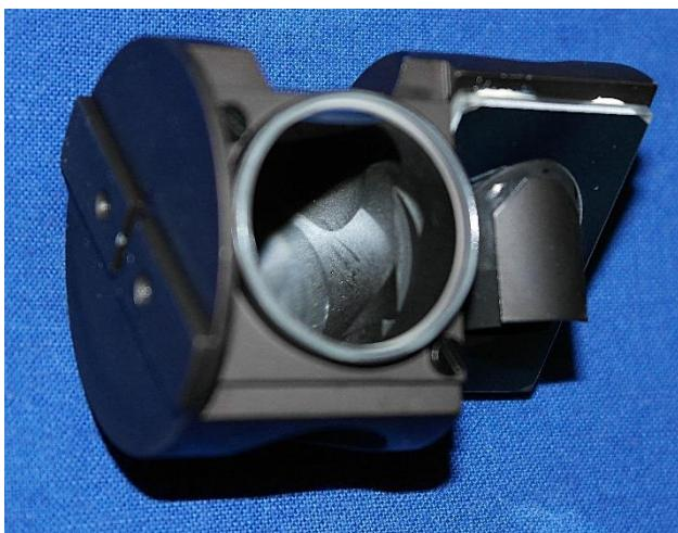
Im Bild links sehen wir den Reflektoreenträger. Seine linke Fläche ist das Gegenstück, auf das die Zwischenplatte aufgebracht wird. Man erkennt den rechteckigen Steg mit einer Rechteckrinne in ihrer Mitte; in diese greift der Stift der Exzentschraube und überträgt so beim Drehen der Schraube die Bewegung.
