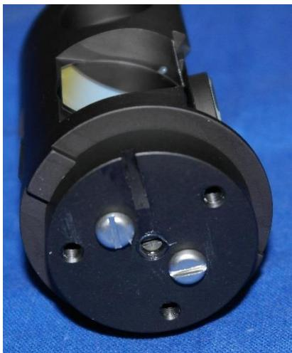
Die Zwischenplatte ist auf dem Reflektoreenträger aufgeschraubt.
