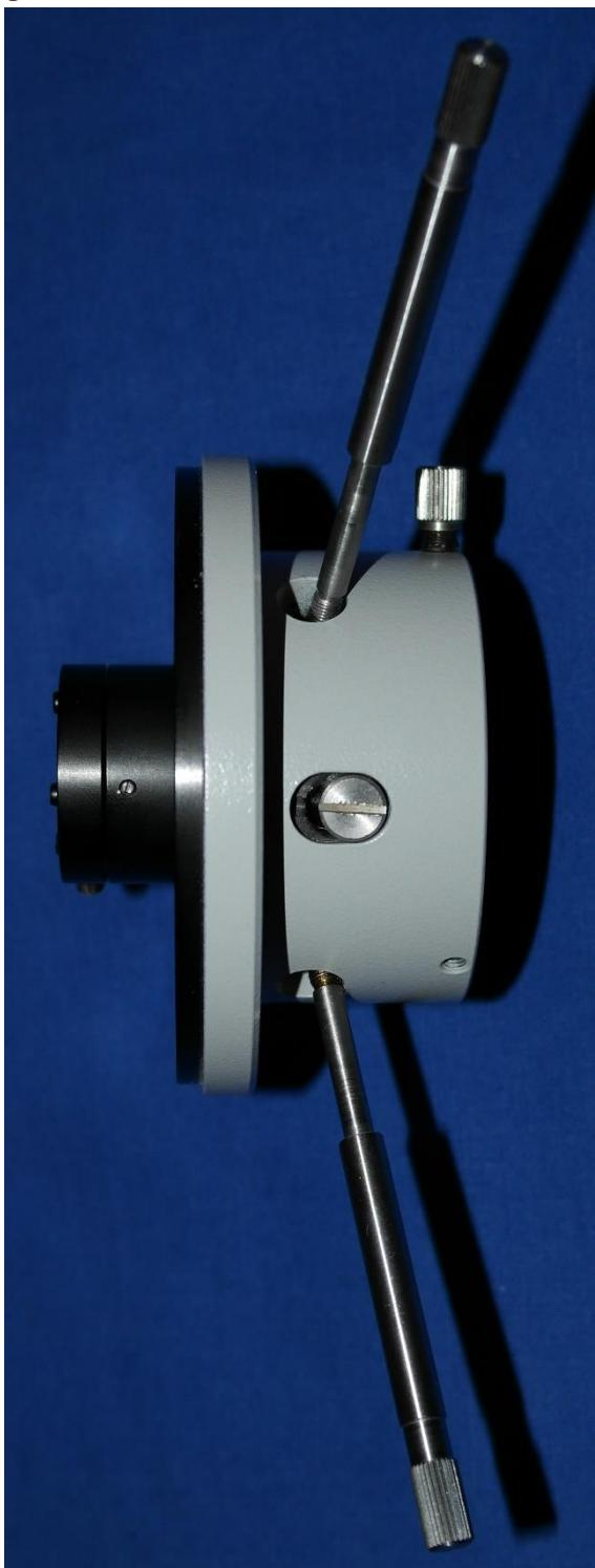
Im Bild links Blick auf die zusammengebaute Grundplatte von oben. Zwischen den beiden Zentrierschrauben sieht man die Führungsschraube für den Fokus. Ihr genau gegenüber liegt die Schraube des Federmechanismusses.
