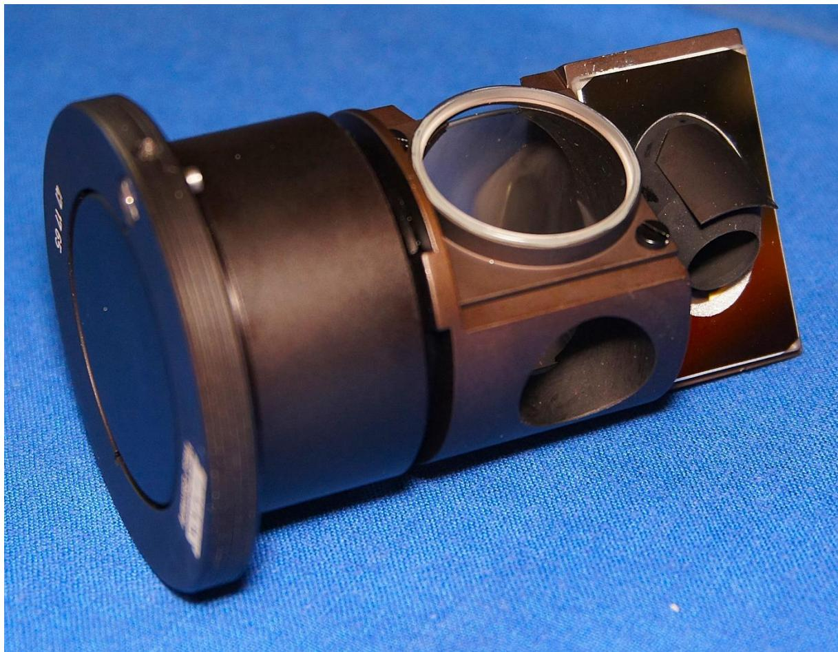
Die Mechanik für die Justierung der Schieber HD (47 17 65) und der Fluoreszenzschieber 2FL (46 63 01) für die Mikroskope IM und den Auflichtilluminator IV FL der Standard-Mikroskope ist identisch.
