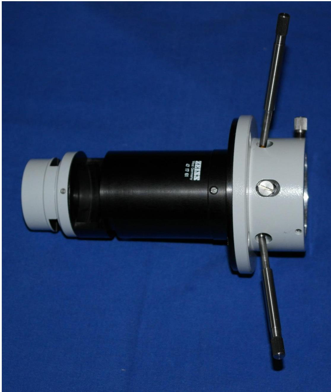
Hier sieht man den Ansatz FL. Rechts die grau lackierte Leuchtenaufnahme mit den langen Zentrierschrauben (sind gerne einmalverbogen) für die Leuchtfeldblende. Blendenstellhebel und Filterschieber sind -wie für den Ein- und Ausbau erforderlich- entfernt.
