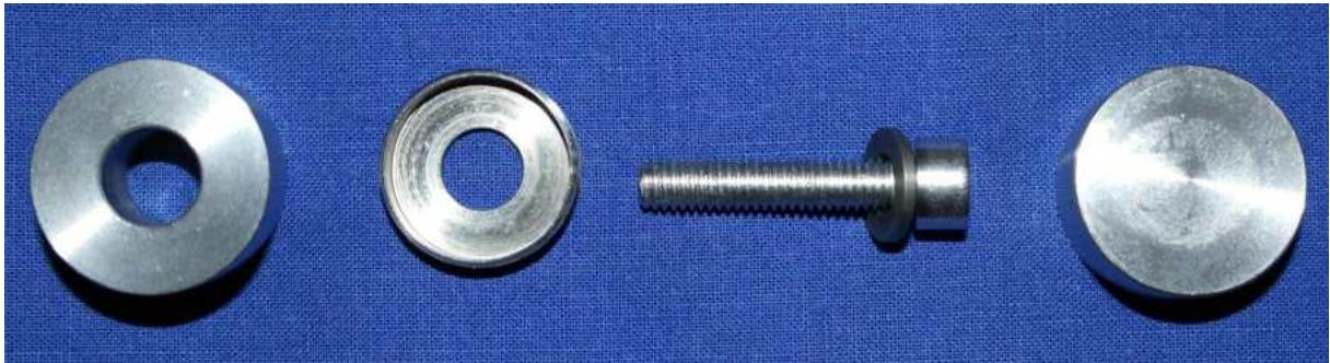
Links die Distanzhülse (15mm Höhe), rechts daneben die Schraubverbindung zur Kappe; sie wird mit einer Schraube M6x30 mit Unterlegscheibe zusammen mit der Distanzhülse fest auf den Stativbodengeschraubt. Das Ganze wird dann mit einer geschlossenen Abdeckkappe (12,5mm Höhe Linksgewinde) abgeschlossen. Auf die Abdeckkappe kommt dann noch ein passender, dünner Filzgleiter.
