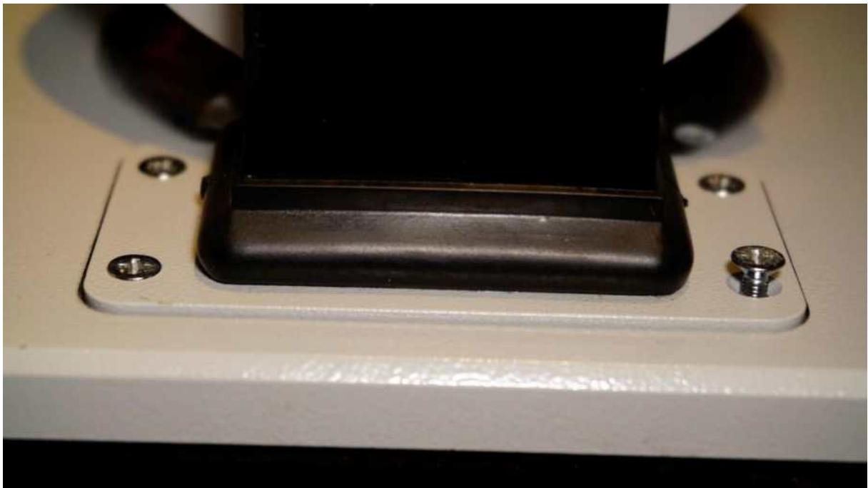
Nun noch die Abdeckplatte anbringen und festschrauben. Zuletzt können die Bedienknöpfe wieder angebracht werden. Die Grobtriebknöpfe werden ja auf die Achse aufgeschraubt, dabei bitte nicht gegen das Gewindeende „festknallen“, das könnte zu Problemen führen, wenn man sie später noch einmal abnehmen muss. Beim Kontern mit der Mutter den Triebknopf festhalten!
