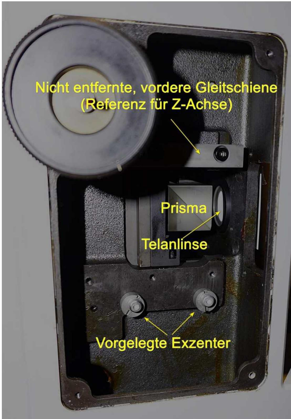
Revolverschlitten über das rechteckige Fenster einführen (nirgends hängenbleiben und Teile verlieren). Etwa in der Längsrichtung zentriert den recht schweren Schlitten nach
