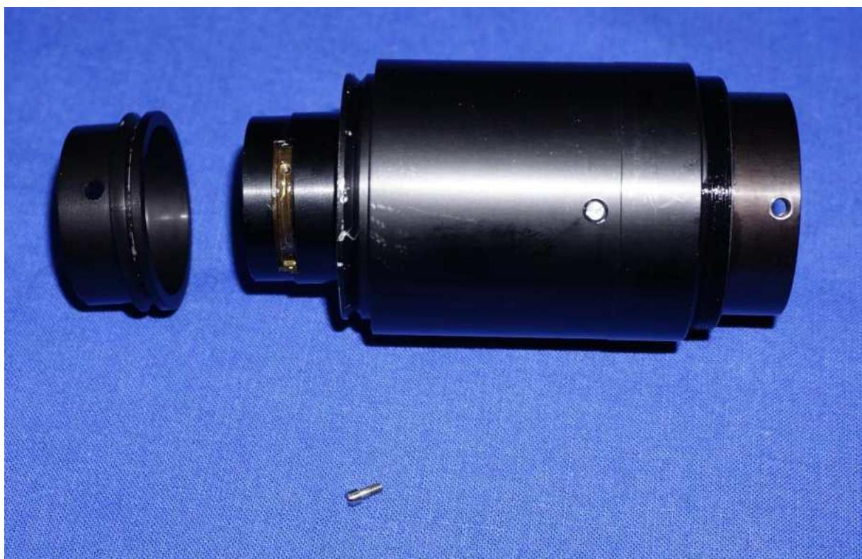
Bis jetzt sind die Teile nur locker zusammen. Der Blendenkörper und die übergestülpte Hülse lassen noch kein sicheres Einrasten der Mitnehmerschraube im
