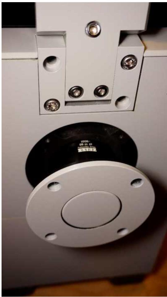
Hinter der kleinen runden Abdeckung finden sich die Befestigungs- und Stellelemente für den Umlenkspiegel; das Kompartiment habe ich unberührt belassen, da keine offensichtlichen Probleme mit der Spiegeljustage bestanden.
