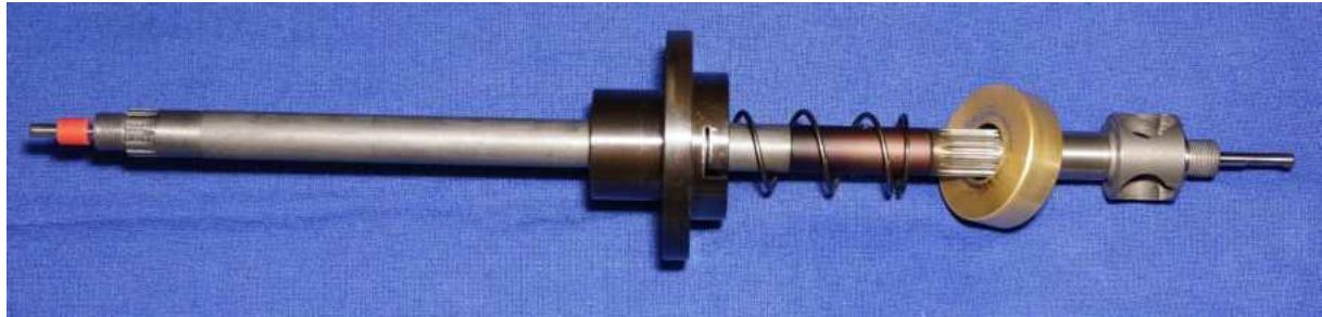
Das folgende Bild zeigt die rechtsseitigen Enden der Achsen von Fein- und Grobtrieb. Zusammengesetzt laufen die Kugeln auf einem ausgedünnten Segment der Feintriebachse. Die Abflachung am Ende der Feintriebachse dient als Widerlager für die Inbusschraube, mit welcher der Feintriebknopf auf der Achse fixiert wird.
