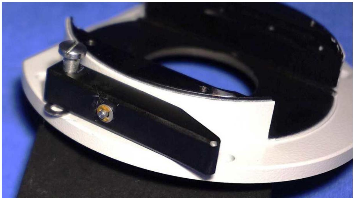
Der Hebel ist aufgesetzt, ein weiterer Sicherungsring auf einer silbernen Unterlegscheibe hält ihn in Position. Er wird in der gezeigten Weise mit dem Gehäuse verschraubt. Die große Beilegscheibe liegt zwischen Hebel und Gehäuse.
