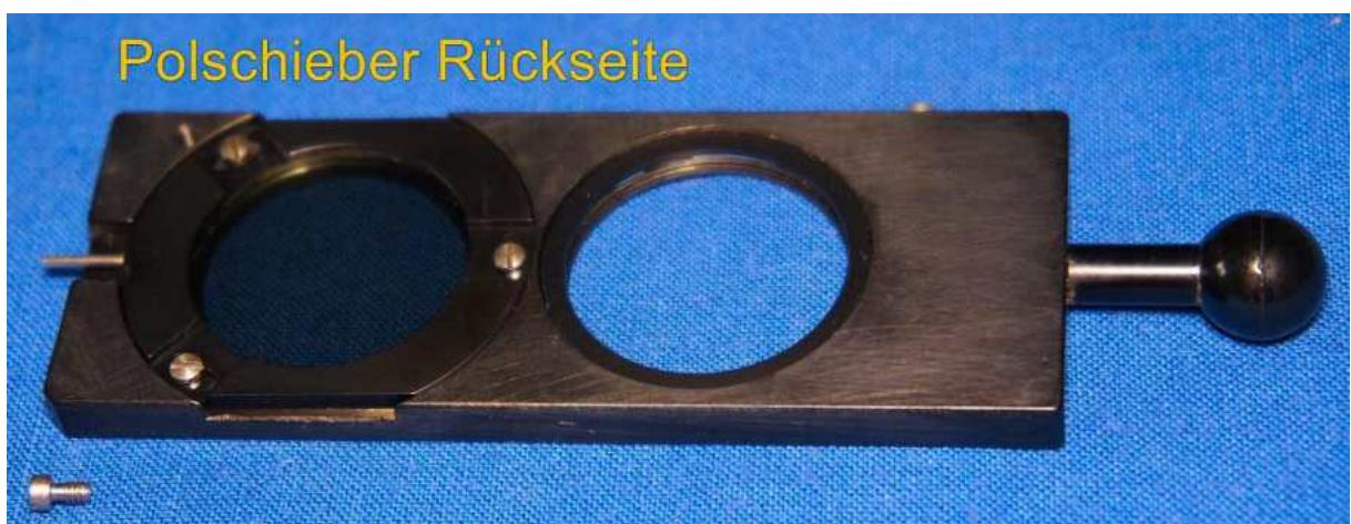
Hier war nur eine sorgfältige Reinigung nötig. Der Schieber kann nur aus dem Fach entfernt werden, wenn zuvor die auf der linken Seite nach vorne zeigende Anschlagsschraube herausgedreht worden ist
