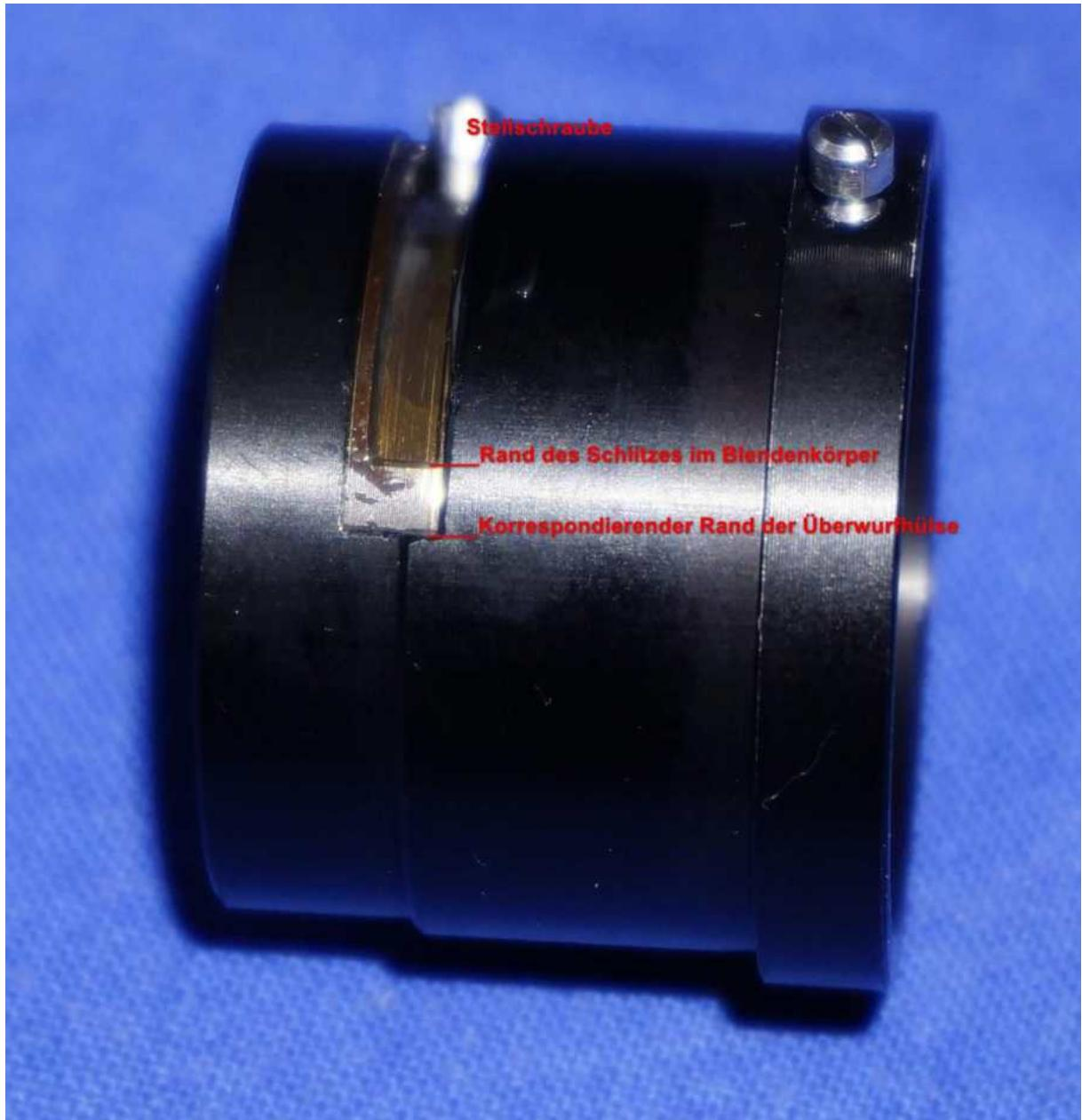
Nun wird die Blende innerhalb des übergestülpten Gehäuses so positioniert, dass an einem Anschlag die maximale Öffnung der Blende gewährleistet ist. Die Anschläge der Schlitze von Blendenkörper und übergestülpter Hülse sind dann nahezu deckungsgleich. In dieser Position wird der Blendenkörper durch Festziehen des dafür vorgesehenen Schlitzschraubenringes fixiert (Bild unten).
