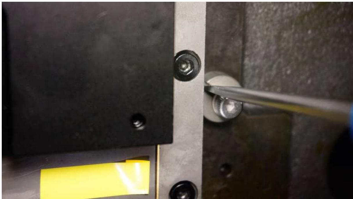
Die hintere Gleitschiene mit den Exzentern gleichmäßig anpressen (abwechselnd oberen und unteren Exzenter allmählich andrehen), mit den Inbus festsetzen und schließlich auch die Schiene mit den Inbusschrauben festziehen. Der Revolverschlitten sollte nun kein Spiel mehr haben und trotzdem noch frei, nahezu reibunglos laufen.
