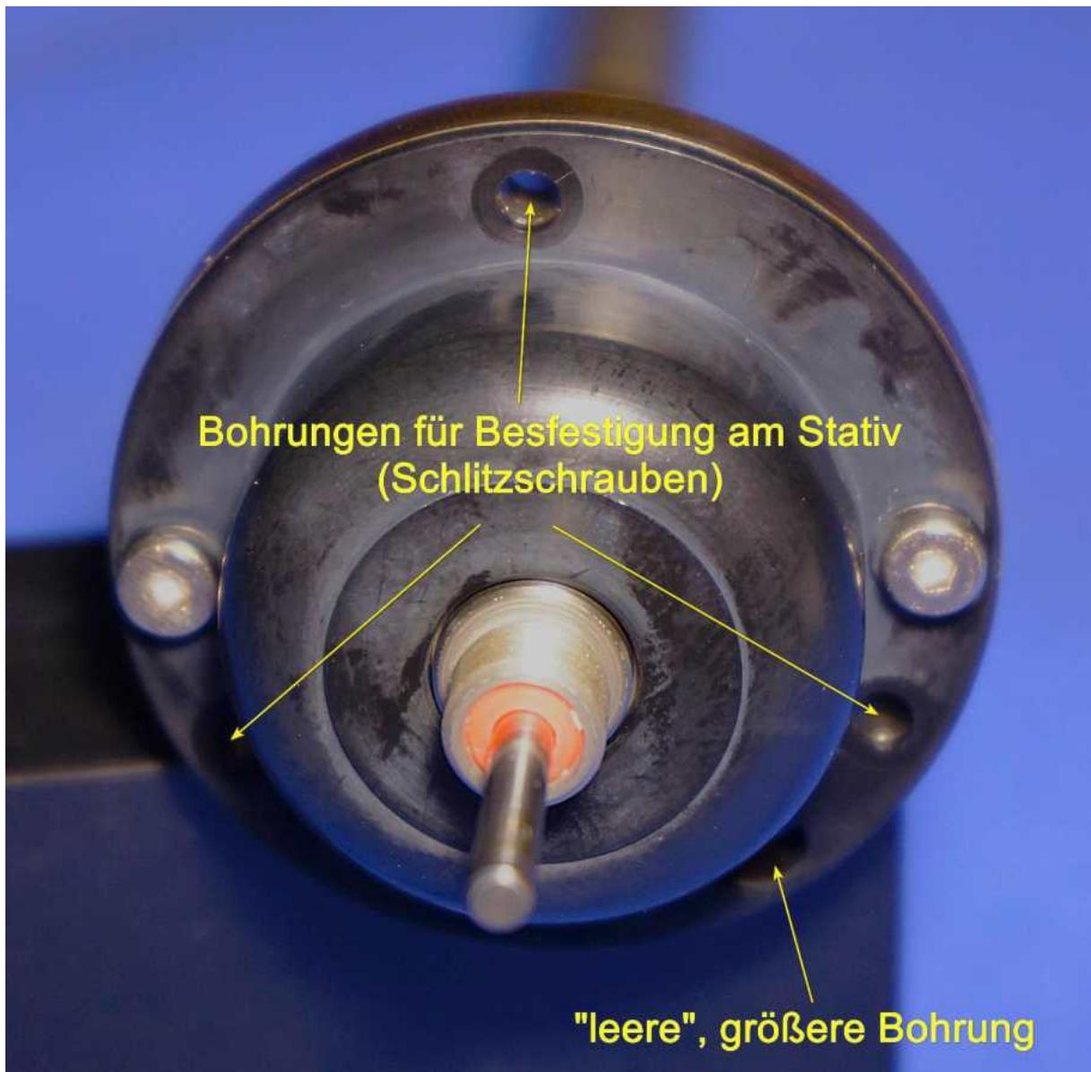
Rechts unten im Bild, etwa bei 5 Uhr, erkennt man die oben beschriebene, große und leere Bohrung, sie kann später als Ausrichtungshilfe genutzt werden.
