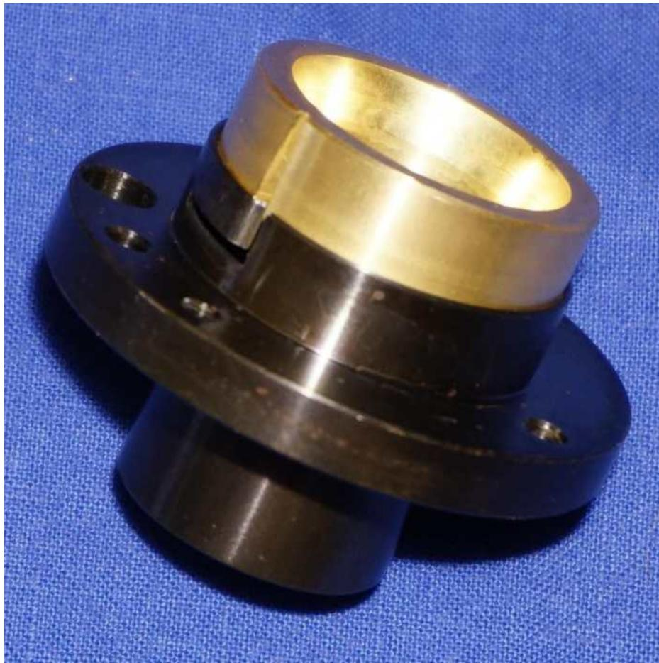
Zuletzt kann die Kunststoffabdeckung aufgeschoben werden. Sowohl die Abdeckung wie auch das Achslager weisen eine große Bohrung auf, die mit keiner Schraube belegt wird; die entsprechenden Bohrungen werden übereinandergelegt. Jetzt kann das Kunststoffteil über die beiden erhöhten, gegenüberliegenden Bohrungen mit zwei Inbusschrauben mit dem Achslager fest verschraubt werden. Die Wäscheklammer kann nun abgenommen werden, die Teile springen nicht mehr auseinander.
