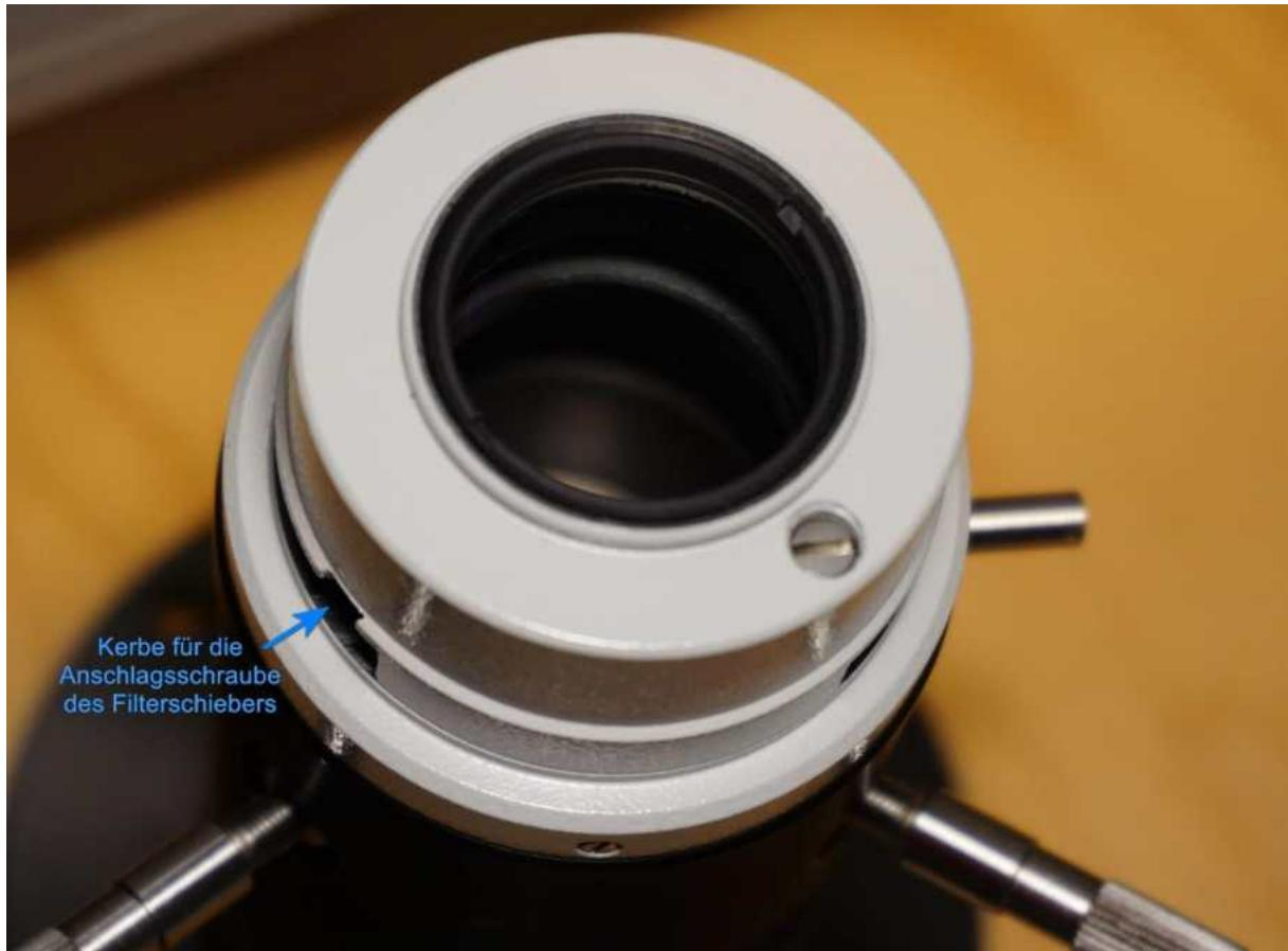
Wenn nun die beiden Teile des Auflichtstrahlengangs in das Stativ eingesetzt werden, muss *zwingend* zuerst *das innere Rohr* von der Rückseite des Statives eingebaut werden (daran denken: Vorher Zentrierschrauben und Blendenhebel entfernen), dabei bitte auf die Ausrichtung achten, das Teil ist rotationssymmetrisch. Erst danach darf das äußere Rohr von der rechten Seite installiert werden, da es in die Spiegelöffnung des inneren Kollektotorohres hineinreicht.
