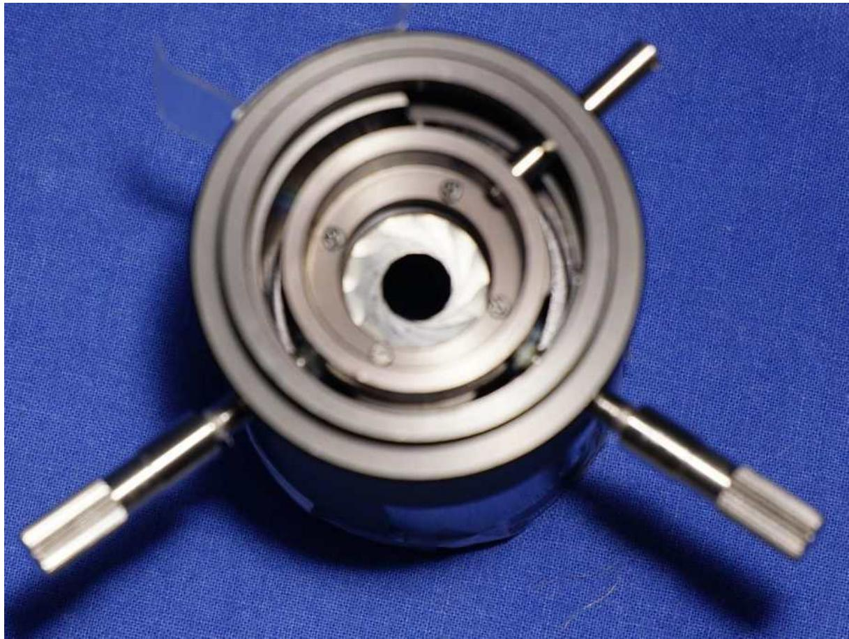
Hier die Abdeckkappe für die innere Kollektorlinse und die Teile der Federrastung für den Filterschieber. Die drei Stiftschrauben zur Fixierung sind bereits eingesetzt.
