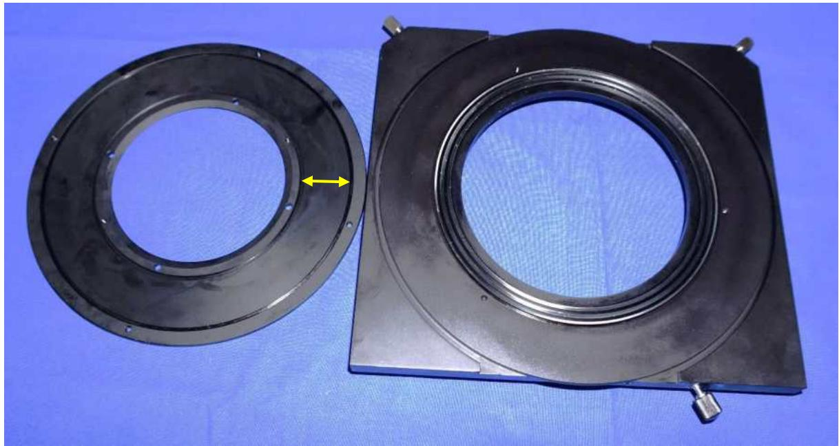
Zum Schluss noch „Veredelung“ der Oberfläche der Gleitplatte des Tisches und der Tischeinlage mit matt-schwarzer Autofolie. Natürlich habe ich aus grauem und strukturiertem ABS-Kunststoff von 1mm Dicke auch für diesen Tisch einen Halter für Standard-Objektträger gefertigt.
