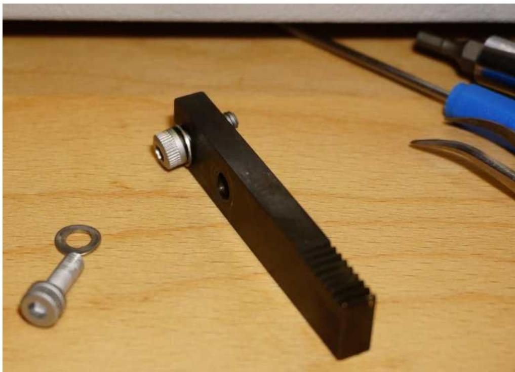
Wie man in den Bildern sieht, wollte ich faul sein und habe die Zahnstange am Revolverschlitten zunächst belassen, das funktioniert beim Einbau nicht, man bekommt das Uhrwerk nicht in Position. Also wurde die Zahnstange abgeschraubt.
