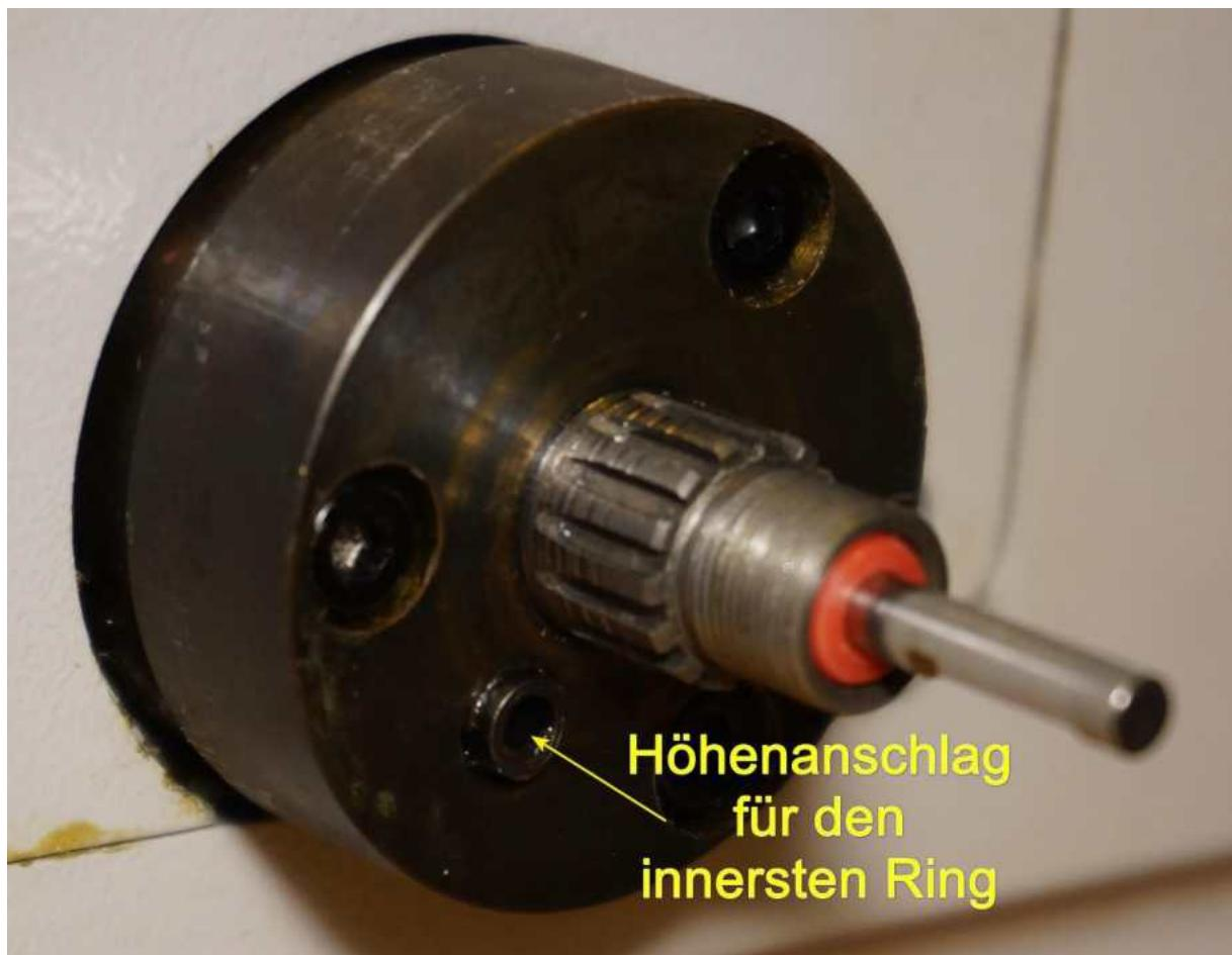
Der erste Ring ist eingesetzt. Die in die rautenförmigen Laschen eingestanzten Noppen müssen nach außen zeigen. Bei der früheren, etwas aufwändiger gefertigten Variante waren die Laschen selbst auf der einen Seite nach außen 90° umgebogen, sie waren dtl. stabiler.
