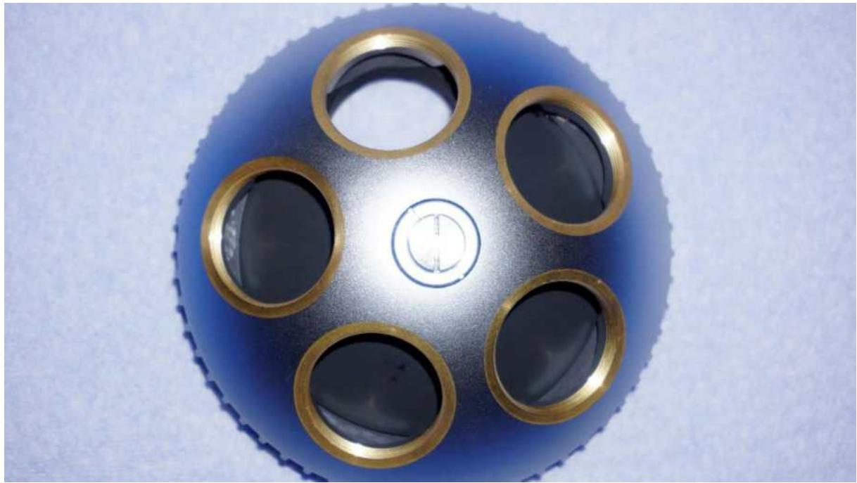
Zum Schluss Kontern mit der Schlussschraube (**Linksgewinde!**). Sie soll fest angezogen werden, dabei die Konusschraube über den Schlitz auf einer Seite mit einem Schraubendreher festhalten, damit sie sich nicht mitdreht.
