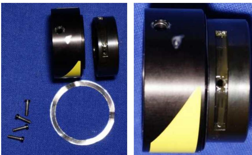
Das Bild links zeigt noch einmal den Stellring, den Federring und die Blende in der Anordnung, wie sie zusammengesetzt werden. Die vier Schrauben werden von links in den Stellring eingebracht. Rechts sehen wir die
