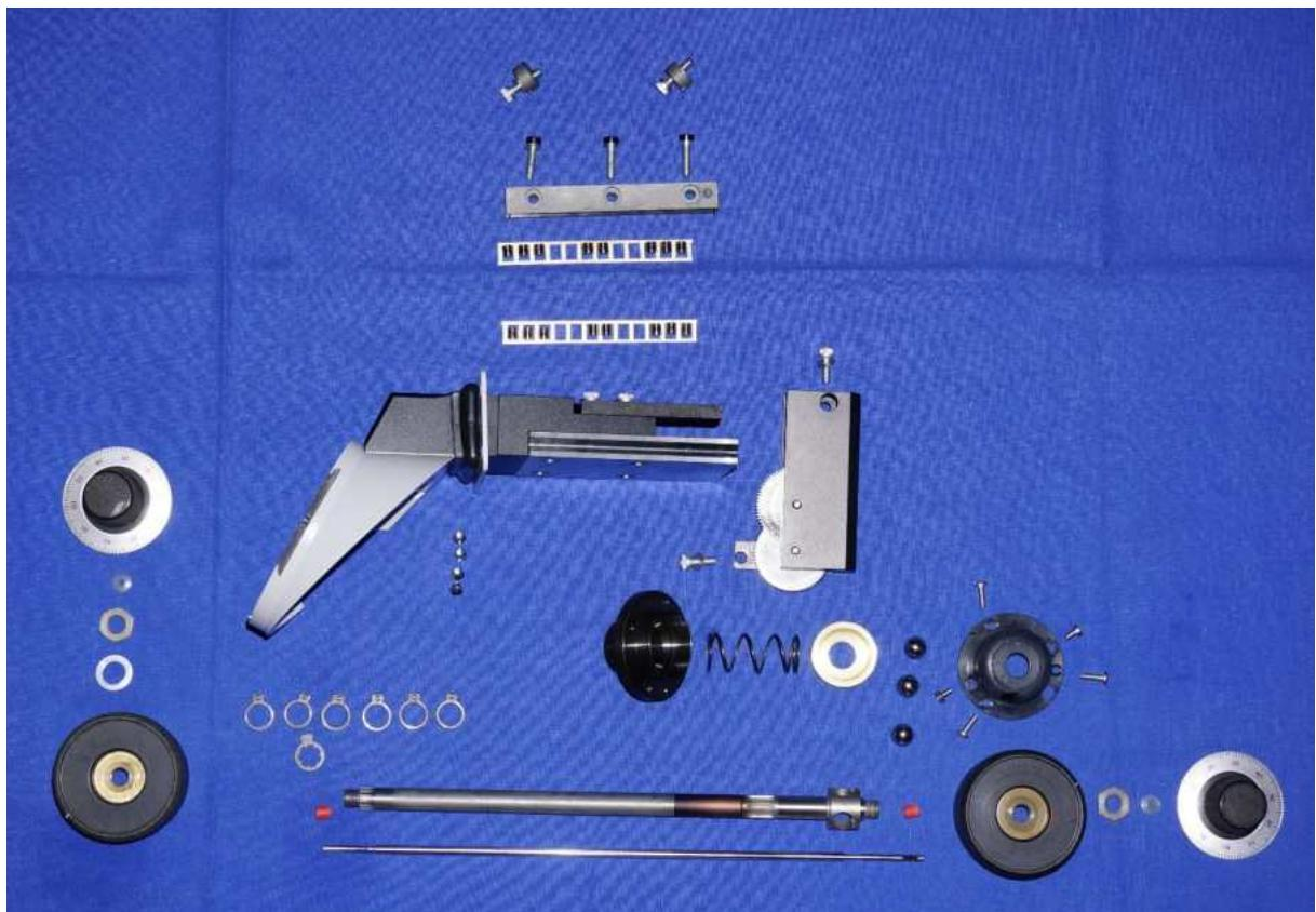
Hier zunächst das Uhrwerk. Es besteht aus dem Gehäuse sowie zwei identischen Doppelzahnradern und ihren zugehörigen Achsen.
