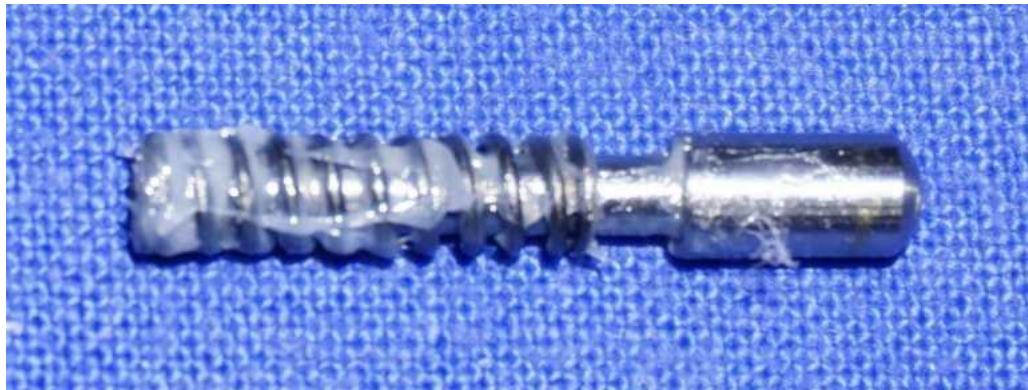
Im Bild oben sieht man den Bolzen, eingeschoben in die Feder und gut mit Fett versorgt (Zeiss HP 150). Die Doublette wird von innerhalb der Ringschwalbenaufnahme in die Hülse eingeführt. Außen schaut dann der Stift heraus und muss hier mit einem Sicherungsring en miniature fixiert werden:
