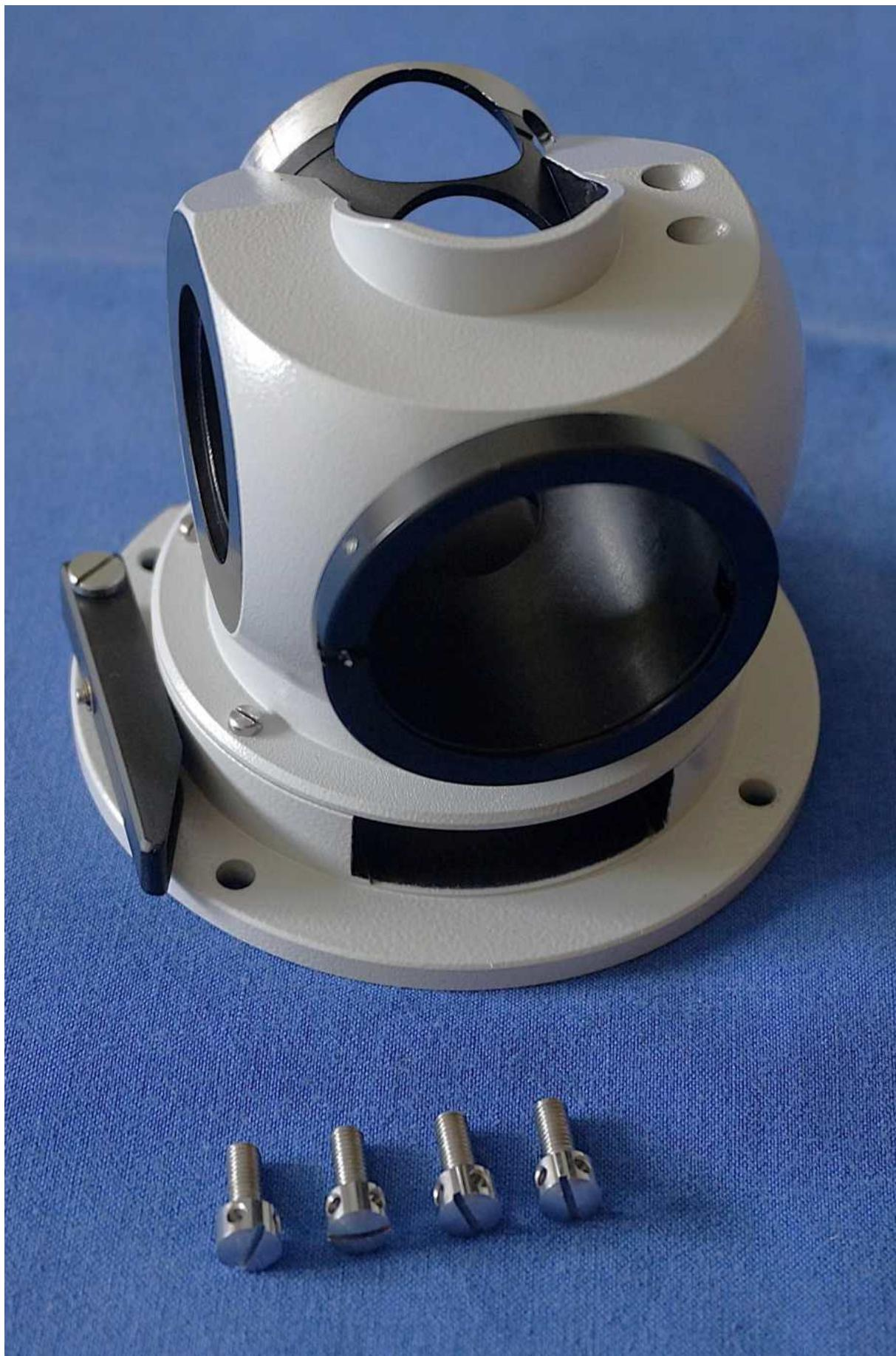
Sicher wäre es einfacher, den Turm schon einzubauen, bevor der Schlitten mit der Revolveraufnahme wieder eingesetzt wird, da man dann freien Zugang zu allen vier Schrauben von oben hätte. Das habe ich nicht gemacht, da ich noch einmal testen wollte, inwieweit bei entsprechendem Umbau eine Integration des „alten“ Zeiss-DIC möglich wäre. Um diesen Versuch kurz zusammenzufassen: Es geht nicht, man bräuchte für den Hauptschieber ein anderes Prisma!
