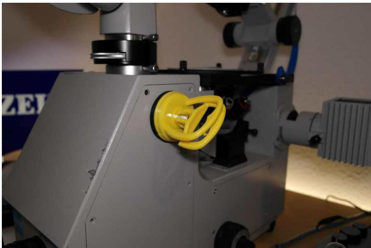
Damit gelingt das Abheben u.U. auch ohne Hitze oder Lösungsmittel (langsam ziehen). Nimmt man ein Lösungsmittel, so wird dieses Fettwachs ja angelöst; man ist dann leicht versucht, die Auflageränder mit einem Tuch abzuwischen, was man ab tunlichst unterlassen sollte. Die Pampe soll das Ganze ja dann wieder staubdicht verschließen.
