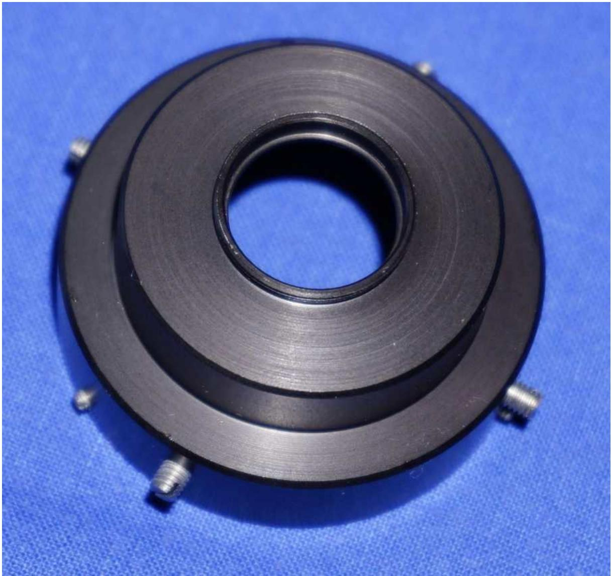
Es sind vier dickere Stifte, die näher am Lampen-fernen Ende liegen (dieses ist auf dem Bild zu uns gerichtet) und in die Nut der im vorigen Schritt aufgebrachten, mittleren Hülse greifen und so die Blende zentrieren, während die drei dünneren Stifte in die Nut des äußeren Tubus fassen und so das ganze fixieren.
