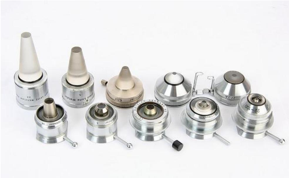
Die okularseitigen Linsen besitzen eine sehr intensive Vergütung und geben zusammen mit der hohen Apertur einen idealen Kondensator für das Erregerlicht ab. Die Reflexminderung erfolgt dann nicht wie bei diesem 11x Objektiv
