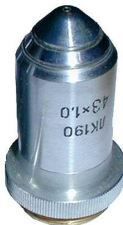
Die Kontaktobjektive ermöglichen es, die inneren Schichten von biologischen Proben sowohl von lebenden Organen kleiner Kreaturen oder Organen nach der Extraktion aus dem Körper zu erforschen. Diese Untersuchungen können im Lumineszenzlicht oder in Auflicht mit polarisierten Strahlen erfolgen. All diese Objektive sind für 190mm Tubus berechnet.
