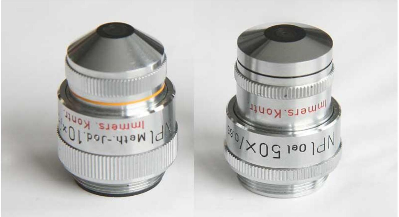
Diesen Objektiven vorgefasst war noch eine drehbare Lambda/4-Platte. Durch diese wird das beleuchtende (polarisierte) Licht depolarisiert. Das an den Linsenflächen reflektierte (kontrastmindernde) Licht behält die Polarisation bei und kann vom Analysator gesperrt werden.
