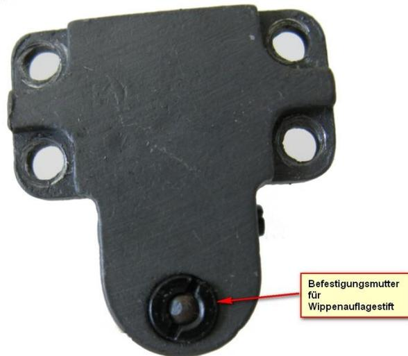
Die Befestigungsmutter wird abgeschraubt und die Wippe seitlich entfernt. Dann kann der Wippenauflagegestift herausgezogen werden. Nach Aufstecken einer DÜNNEN Unterlegscheibe wird alles wieder in umgekehrter Reihenfolge zusammengebaut. Anschließend Spielfreiheit und Leichtgängigkeit prüfen! Ist noch Spiel vorhanden, muss die Unterlegscheibe dicker sein, ist der Trieb schwergängig, muss eine dünnere Unterlegscheibe verwendet werden.
