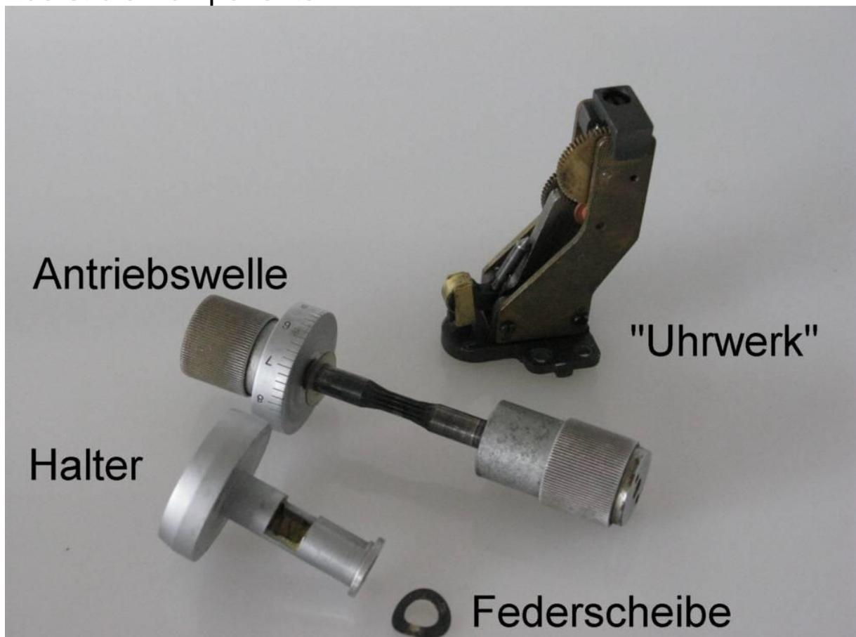
Der eigentliche Uhrwerksantrieb wird durch die Antriebswelle betätigt.
