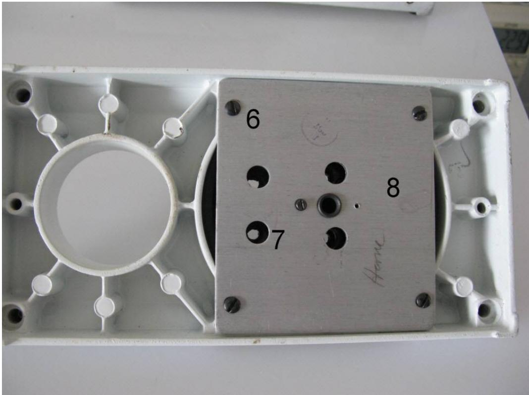
Unter dem Fuß befindet sich eine Platte (8) welche mit 4 Schrauben (6) am Fuß befestigt ist.
