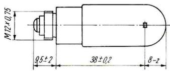
Lichtwurf Lampe T-P5-6 V; 15 W nach TGL 10619 mit Flachkernwendel
