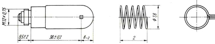
Lichtwurf Lampe T-P1-6 V; 15 W nach TGL 10619 mit Rundkernwendel
