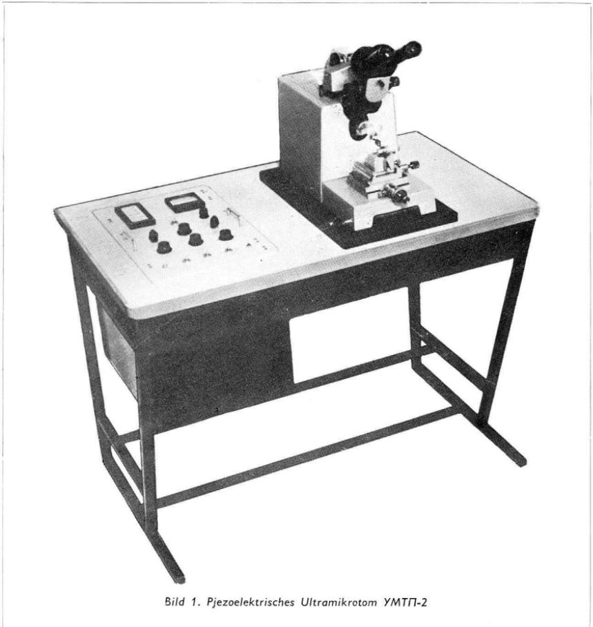
Bild 1. Piezoelektrisches Ultramikrotom УМТП-2
