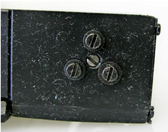
Mit der mittleren Schraube wird die Position des Spiegels über der Lichtaustrittsöffnung eingestellt; mit den drei anderen Schrauben kann der Neigungswinkel des Spiegels verändert werden, so dass der Lichtstrahl mittig durch das Objektiv austreten kann.
