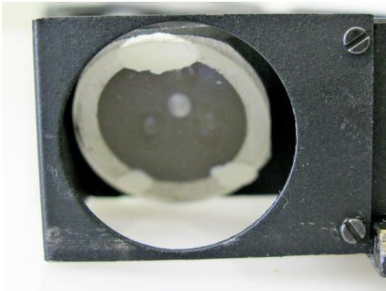
Die Spiegel beider Einschübe sind über ein raffiniertes Schraubensystem präzise ausrichtbar.
