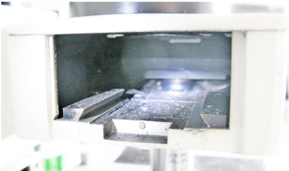
Einblick in den Mikroskopkopf mit Führungen und Anschlag für Einschub
