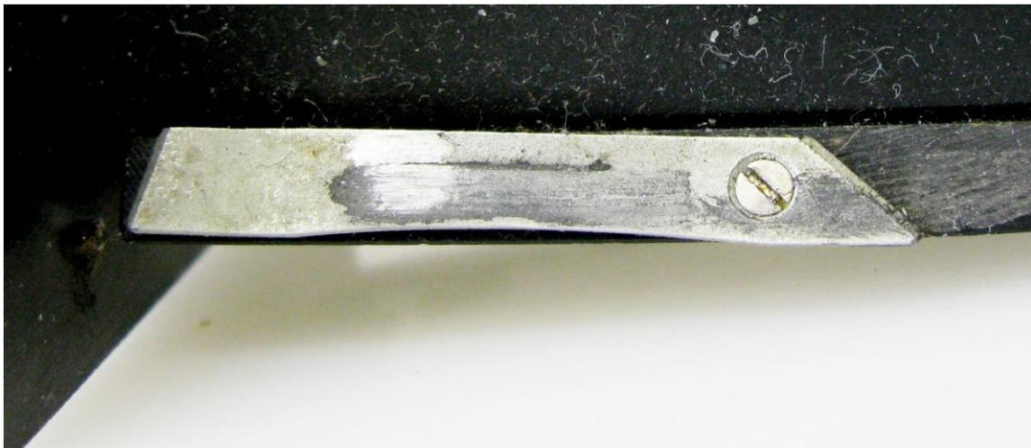
Die Feder ist mit einer Senkschraube befestigt und verfügt über einen einstellbaren Anschlag.
