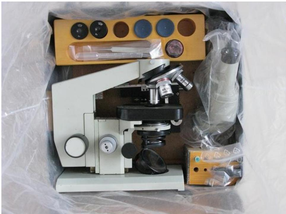
Der aus Blech bestehende Transportkoffer ist innen mit einem Kunststoff-futteral versehen, welches über dem verpackten Mikroskop gegen eindringende Feuchtigkeit verschlossen werden kann. Auf dem unten liegenden Holzboden sind die Halterungen für Zubehör angebracht.
