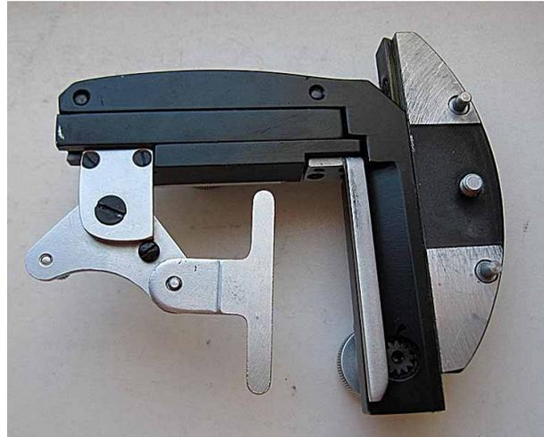
Der Objektführer CT-11 ist für den Einsatz an Polarisationsmikroskopen bestimmt. Er ist für Objektträger im „Gießener Format“ eingerichtet; es können aber auch herkömmliche Objektträger verwendet werden, wobei dann die Drehbewegung des Tisches eingeschränkt wird.
