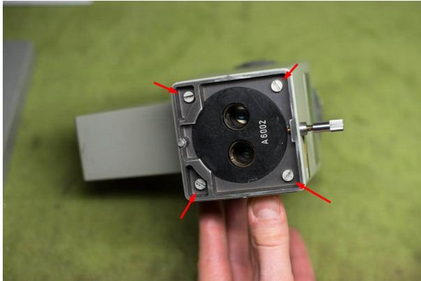
4 Schrauben auf der Oberseite des Grundkörpers lösen. Die Gehäusehülle kann nun nach unten abgenommen werden.
