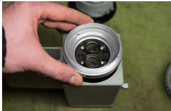
Der letzte Ring, der entfernt werden muss, ist mit 3 Madenschrauben befestigt. Diese müssen alle recht weit herausgedreht werden, so dass sie etwa 1mm außen überstehen. Dann sollte der Ring leicht abzuheben sein. Sinnvoll ist es auch hier, die Position der Madenschrauben an dem innersten Ring zu markieren. Position des nun sichtbaren, schwarzen Teil der Zoom-Mechanik am besten wieder markieren und die Madenschrauben beim Zusammenbauen möglichst wieder in die alten "Kerben" schrauben.
