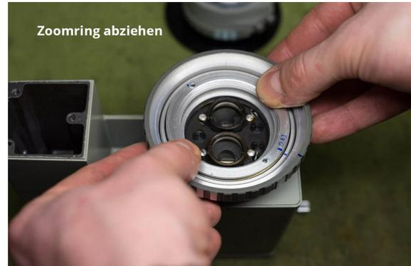
Der Zoomring wird durch eine Madenschraube fixiert, die es zu lösen gilt. Danach kann der Ring abgehoben werden. Schön gerade herausheben, nicht verkanten.
