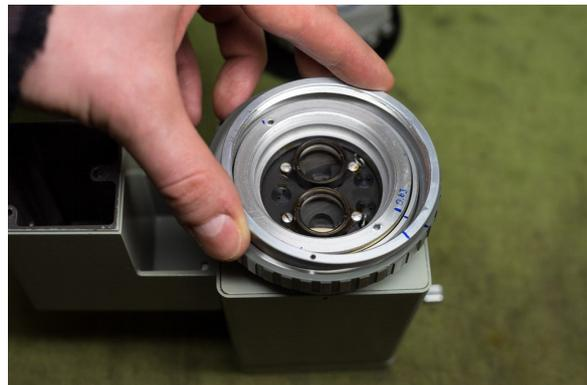
Falls man (wie ich) kein Spezialwerkzeug dafür hat, zwei passende Metallstifte in die Löcher des zweiten Rings von außen stecken und Ring abschrauben. Kann durch verhartetes Fett recht schwer gehen.
