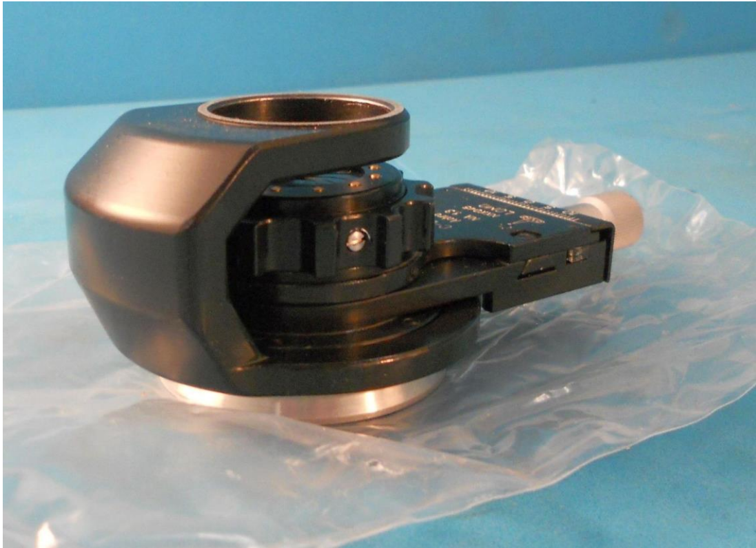
Seitensansicht der Mechanik mit Stellrad für Apertublende.
