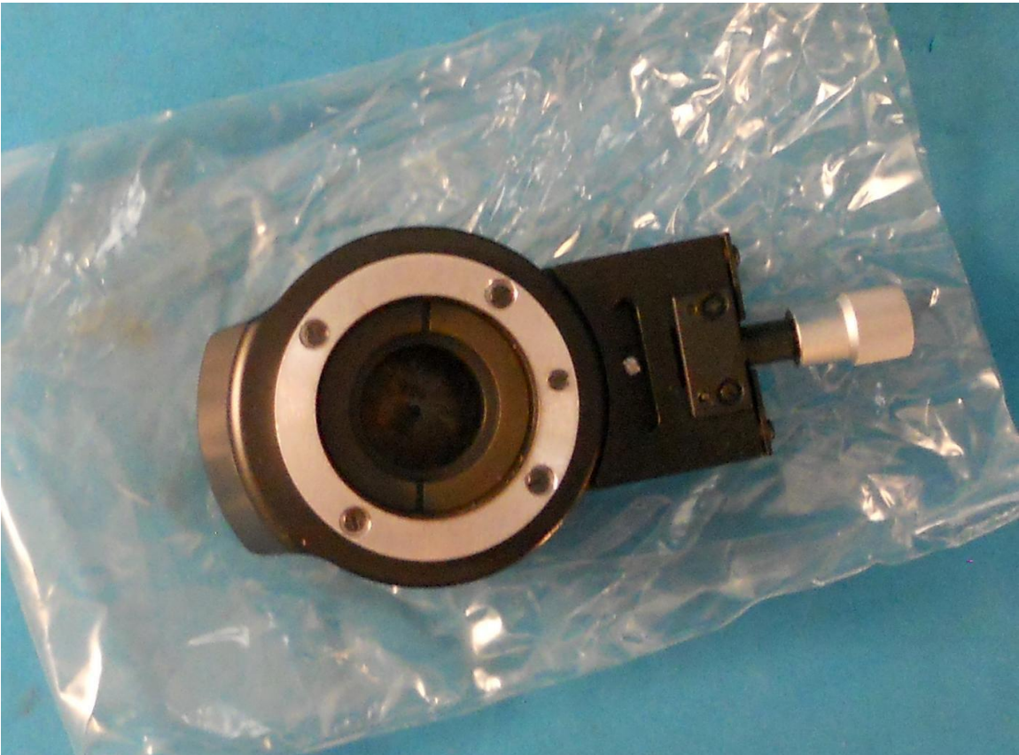
Die Mechanik von unten mit Ringschwalbe für Befestigung.
