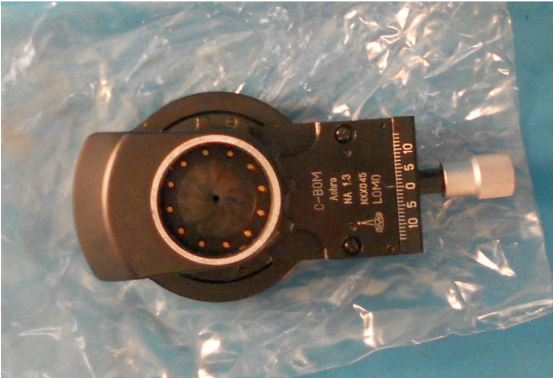
Die Mechanik von oben mit Einstecköffnung für die Kondensoren.
