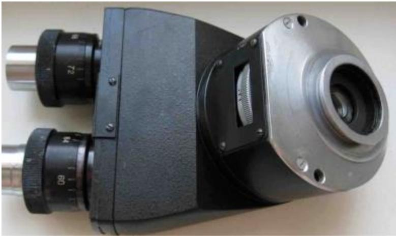
Aus diesem Tubustyp ist der Trinokulartubus MFN-11 entstanden, welche über die gleichen Fähigkeiten verfügt, aber noch einen zusätzlichen Fototubus besitzt. Über einen Schieber kann die Betrachtung auf 100% Bino oder 50/50% Bino/Foto eingestellt werden.
