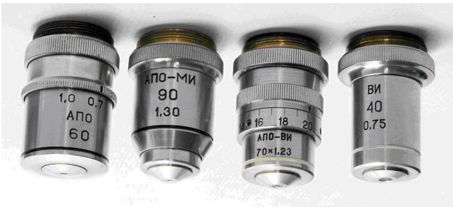
Die Tubusaufnahme ist für Lomo und Zeiss/Jena gleich, so dass beide Fabrikate verwendet werden können.
