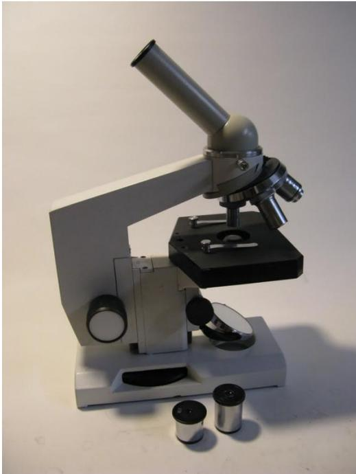
Hier mit „Uhrwerkfeintrieb“, sehr genau und ablesbar; aber schwer zu reparieren
