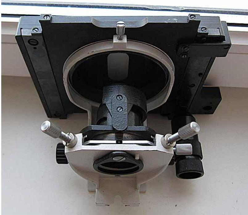
Zur Objektträgerbefestigung dienen im Standardfall Objektklammern
