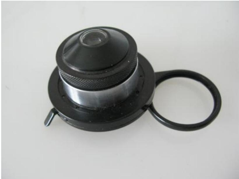
oder w.o. mit NA1,4 und zusätzlicher Klapplinse
