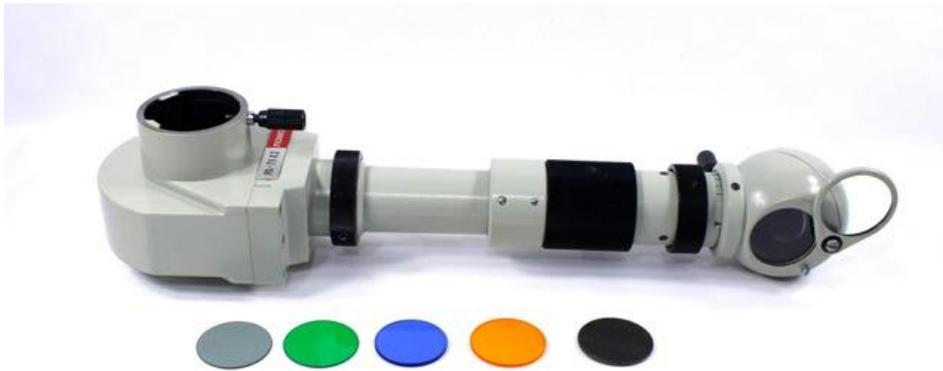
Die Okularstutzen sind mit 23,2mm genormt, so dass die Okulare aller Hersteller passen.
