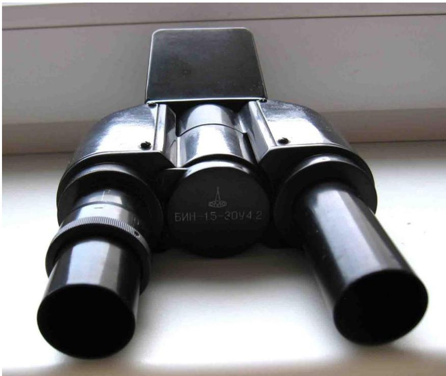
Die nächste Stufe ist der Binokulartubus AY-26. Er verfügt über einen Vergrößerungswechsler mit dem die Vergrößerungen 1,1fach, 1,5fach sowie 2,6fach eingestellt werden können. Zusätzlich verfügt er noch über eine Zusatzlinse für die Einstellung der Ringe bei Phasenkontrast, was die Benutzung eines Einstellmikroskops unnötig macht; eine echte Arbeitserleichterung!
