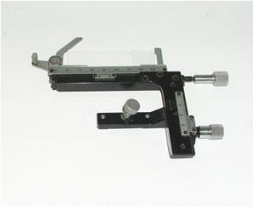
oder der Objektführer CT-11 für Polmikroskope mit „Gießener Format“
