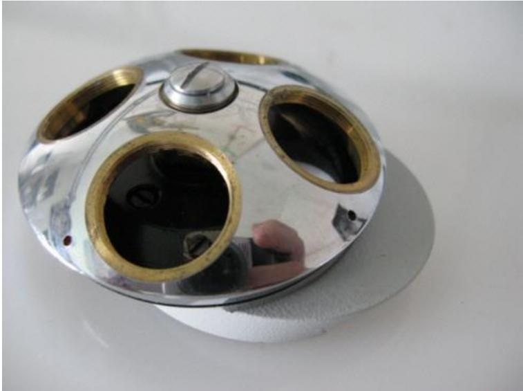
Es kann aber auch der 5fach Revolver von Zeiss/Jena verwendet werden, wobei eventuell die Haltefedern nachgespannt oder gelockert werden müssen; die Schwalbenschwanzbefestigung ist die gleiche.
