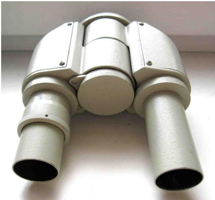
Es können aber auch die Zeiss Tuben mit 1,6facher oder ohne Eigenvergrößerung verwendet werden.
