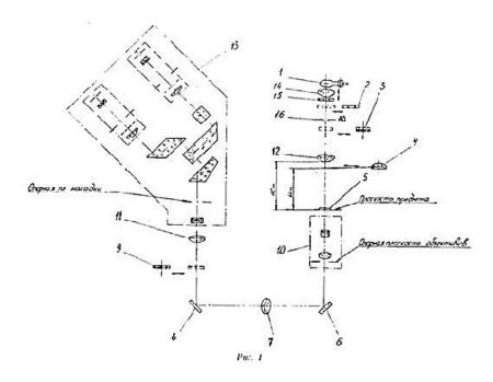
Die Lichtquelle 1 wird durch den Kollektor 14 in die Ebene der Blendenöffnung Blende 16 projiziert und beleuchtet mit Hilfe des Objektivs 12 das Objekt 5 gleichmäßig. Bei der Arbeit mit den Objekten, die in der Höhe bis 44 mm im Gefäß sind, wird im Laufe der Strahlen auch das Objektiv 4, das die Blende der Beleuchtungseinrichtung vergrößert, eingeführt. Der Lichtfilter 15 ist hitzebeständig, mattiertes Glas 2 wird beim Arbeiten mit einem Objektiv 2,5 x 0,08 in den Strahlengang eingebracht.
