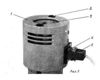
Um eine durchgebrannte Lampe <u>KGMN 6-30</u> zu ersetzen, ist es notwendig, den Stecker 5 mit dem Kabel aus der Fassung 4 zu entfernen, die Schrauben 2 mit einem Schraubenzieher herauszuschrauben und die äußere Abdeckung zu entfernen.
