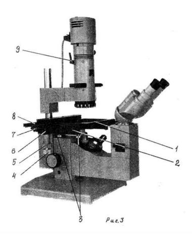
Der Halter 2 besteht aus zwei zueinander senkrechten Führungen 8 und 7, die durch das Gehäuse 6 mit den Griffen 5 und 4 auf derselben Achse starr verbunden sind. Durch die Drehung dieser Griffe wird die Palette 1 bewegt, in der sich das zu prüfende Objekt befindet. Je nach Form und Größe der Laborschalen in der Palette können spezielle Einsätze 1 (Abb. 4) installiert werden, um darauf Gefäße mit Gegenständen zu platzieren. Das Mikroskopset enthält sechs solcher Einsätze.
