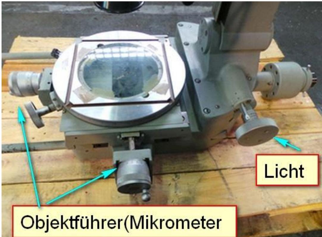
Der Kreuztisch ist mit Mikrometerschrauben für genaue Messungen ausgerüstet
