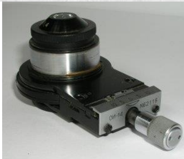
Рис. 8. Кронштейн для конденсоров и конденсоры ОИ-13 и ОИ-14: 1 — кронштейн с направляющей; 2 — крепежный винт кронштейна; 3 — крепежный винт конденсора; 4 — рукоятка вертикального перемещения конденсора; 5 — конденсор темного поля ОИ-13; 6 — апланатический конденсор ОИ-14; 7 — центрировочные винты конденсора ОИ-13.
