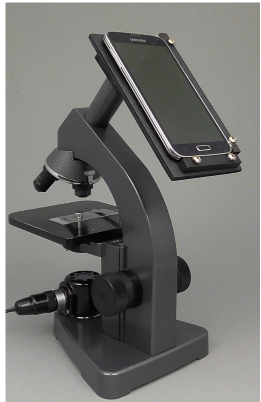
Selbstbau-Smartphone-Auflage; Bau und Foto: Hubert Weber
