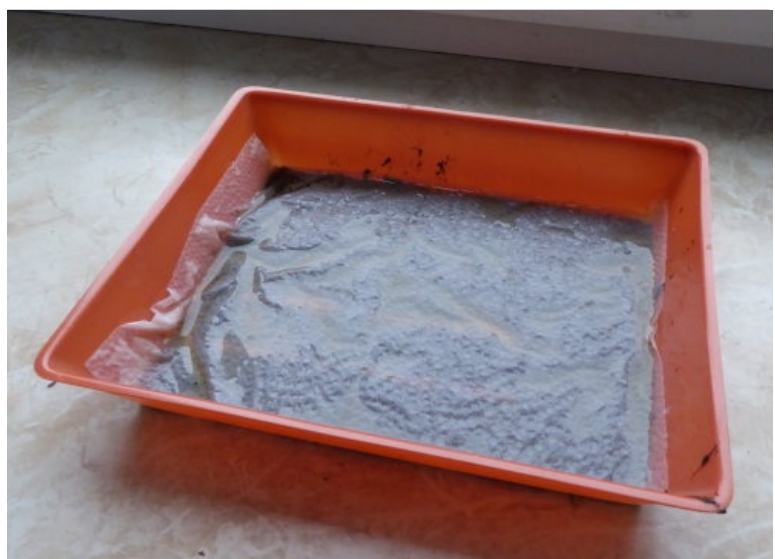
Küchenrolle über einer Schlammprobe in einer Fotoschale ausgebreitet; in den kleinen Vertiefungen sammeln sich die Kieselalgen, die durch das Tuch zum Licht kriechen.
