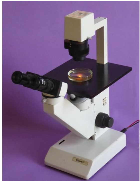
Inverses Durchlichtmikroskop "Wilovert" der Firma Will-Wetzlar
