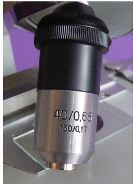
Ein Objektiv der Firma Carl-Zeiss-Jena mit den typischen Gravuren
