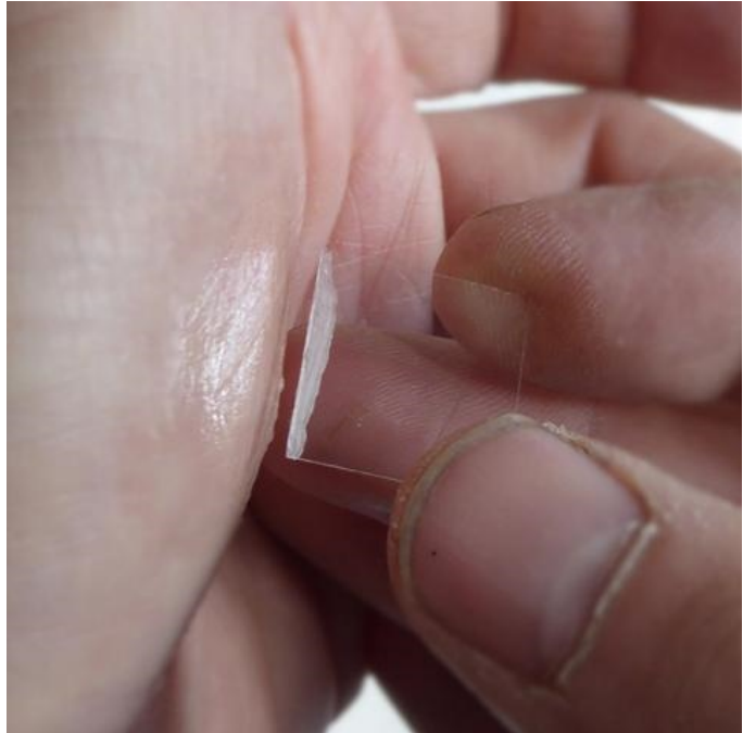
Herstellung von Vaselinewülsten an den Deckglasrändern
