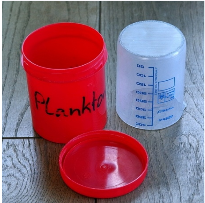
Hier wurde das Edelstahlsieb an Stelle des zuvor abgesägten Bodens auf einen Küchen-Messbecher geschweißt, der in der roten Transportbox verstaut werden kann. Foto Bob Lammert
