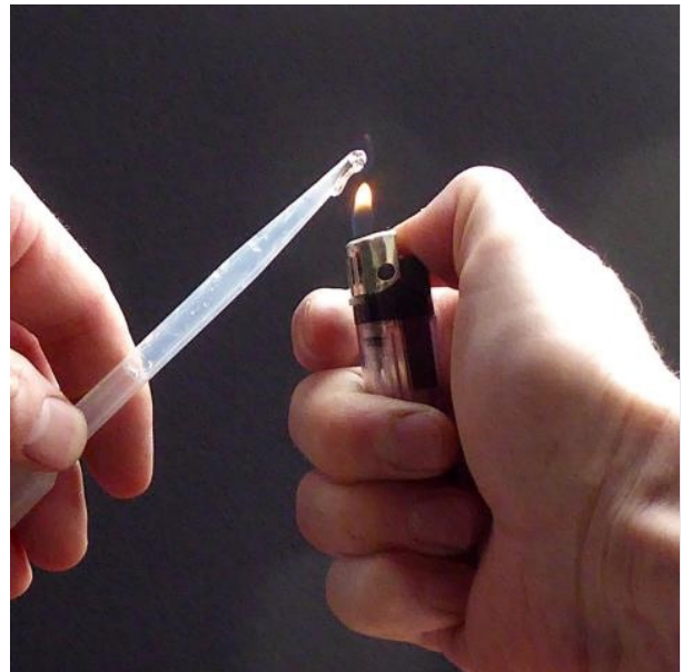
Verschweißen einer Einmalpipette
