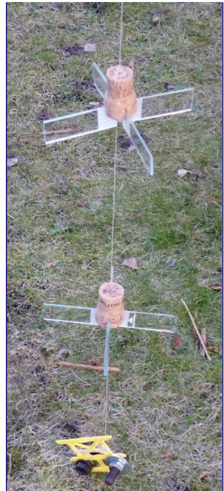
Aufwuchsfalle mit Objektträgerpaaren in unterschiedlicher Wassertiefe. Man kann die OT auch waagerecht anordnen.
