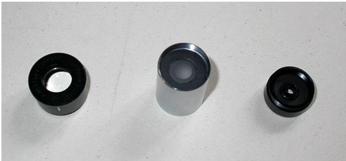
links: Periplan Frontlinse, Mitte : Darstellung des Diffusors auf der Blende und rechts : die Montage des LED-Halters, der die 5mm LED trägt ist erfolgt, alles mit dem ursprünglichen Periplan montiert.
